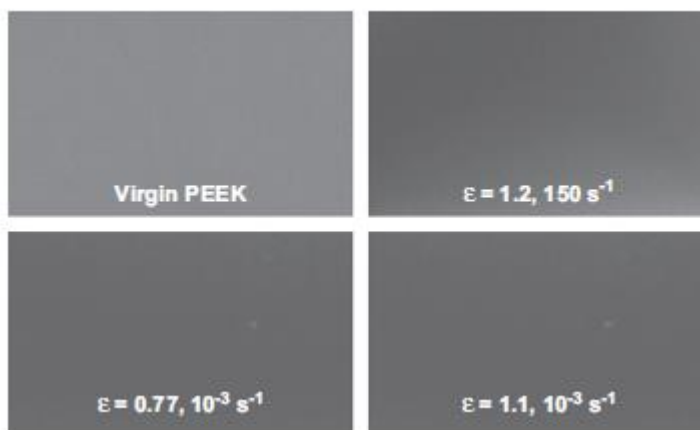
Εικόνα 64 Γυαλισμένες τομές τεσσάρων δειγμάτων PEEK που φωτογραφήθηκαν υπό πανομοιότυπες συνθήκες για να δείξουν την αλλαγή χρώματος που σχετίζεται με την παραμόρφωση μεγάλης παραμόρφωσης. Η τιμή της κλίμακας του γκρι, στο εύρος 0 - 255, όπου το 255 είναι μαύρο, είναι 139 για αγνό PEEK, 178 για \epsilon = 1,2 , 181 για \epsilon = 0,77 και 181 για \epsilon = 1,1 .
