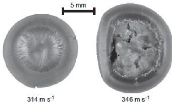
Εικόνα 62 Άκρο σε όψη δύο τυπικών κυλίνδρων Taylor που χρησιμοποιήθηκαν στις 314 και 346 m s -1 . Θερμοκρασία εκκίνησης 23°C.
