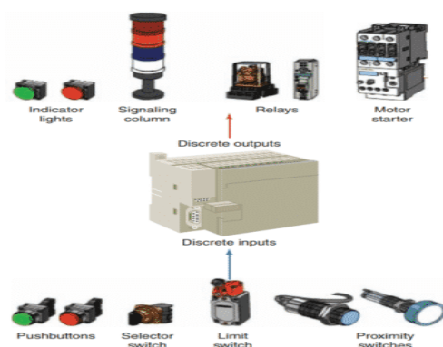
Εικόνα 63-Διάφορες συσκευές εισόδου και εξόδου σε PLC
