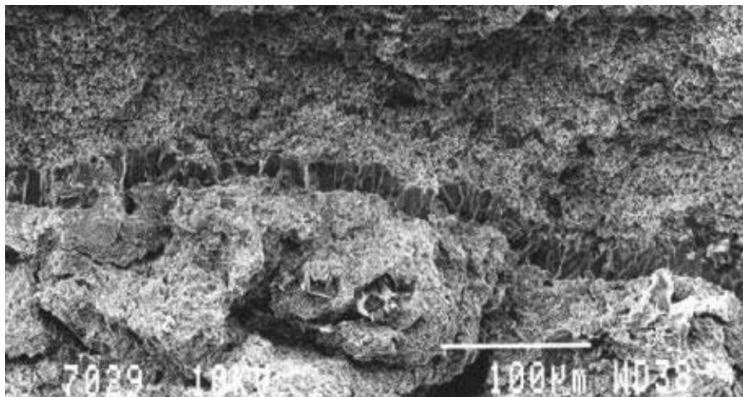
Εικ. 1.4.21: Ανάπτυξη κρυπτοεξανθήσεων διαλυτών αλάτων, μεταξύ υποστρώματος και χρωστικής. Αρχή μηχανισμού δράσης. Εικ. 1.4.22: Λεπτομέρεια
