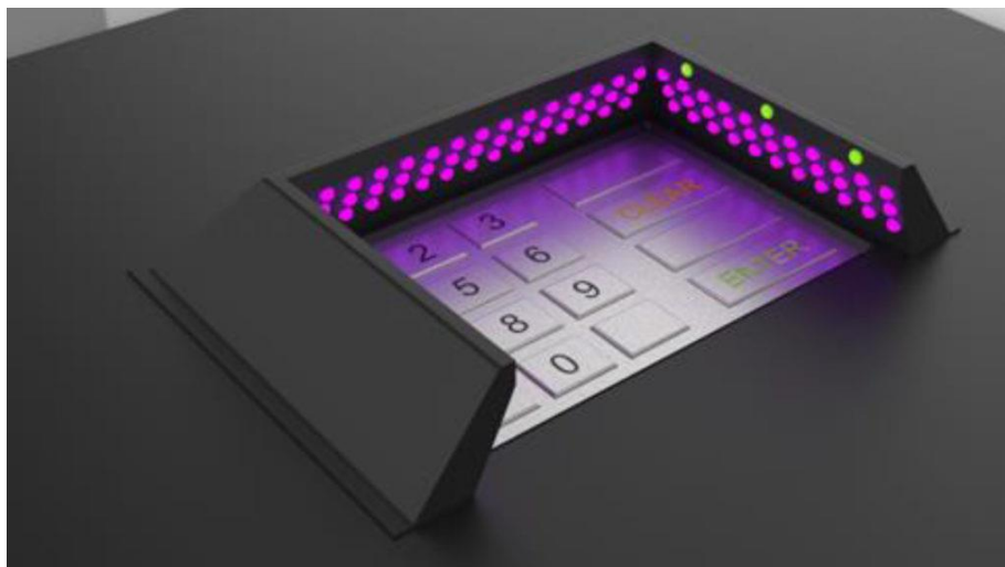
Εικόνα 32-Μικρές λάμπες UV τοποθετημένες σε πληκτρολόγιο
