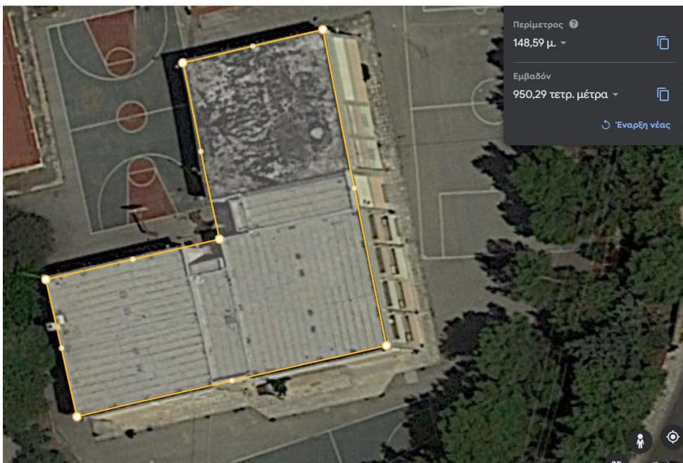
Σχήμα 3.2:Περίμετρος, Εμβαδό Κτηρίου
