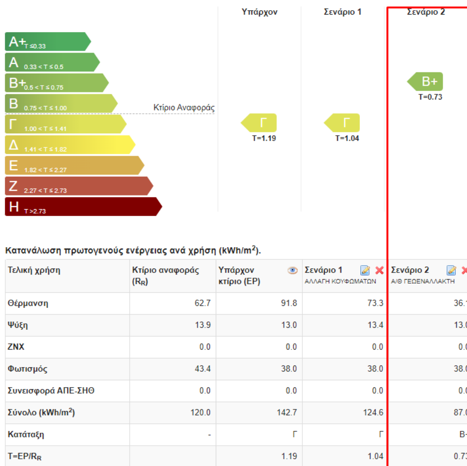
Σχήμα 4. 18: Π.Ε.Α Αντλίας Θερμότητας Γεωεναλλάκτη
