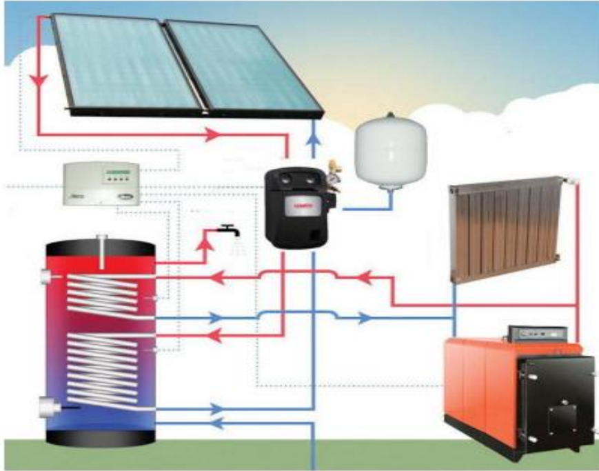
Σχήμα 4. 19: Διάταξη κυκλώματος Ηλιακής Θέρμανσης [34]
