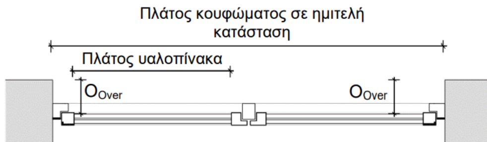
Σχήμα 4. 6: Σκαρίφημα Τοποθέτησης Περσίδας
