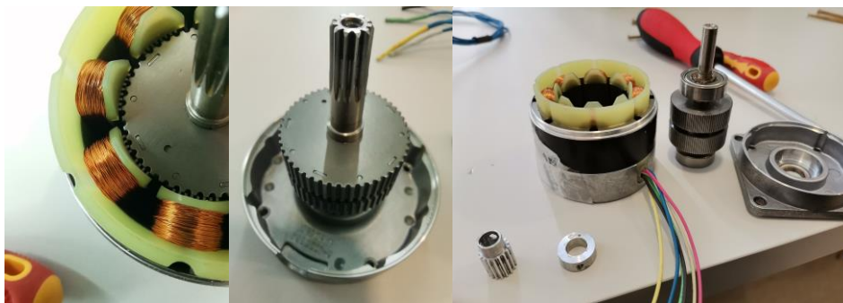
Εικόνα 2.1.4 Το εσωτερικό του βηματικού PH265M
