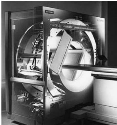
Εικόνα 1.1.2 Ο ασάλινος σκελετός μηχανήματος SPECT της Siemens [3]
