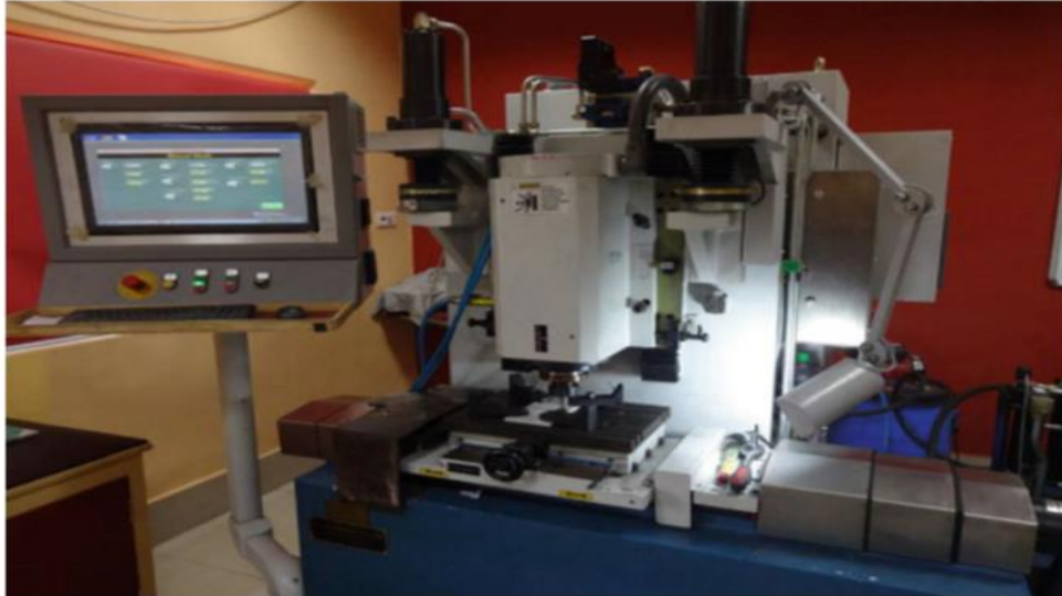
Εικόνα 4.2: Η εγκατάσταση της μηχανής FSW που χρησιμοποιήθηκε στο ερευνητικό πείραμα
