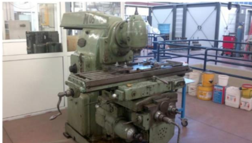
Εικόνα 2.8: Προσαρμοσμένη εργαλειομηχανή FSW εγκατεστημένη στη Σχολή Ναυπηγών Μηχανολόγων Μηχανικών ΕΜΠ [14]
