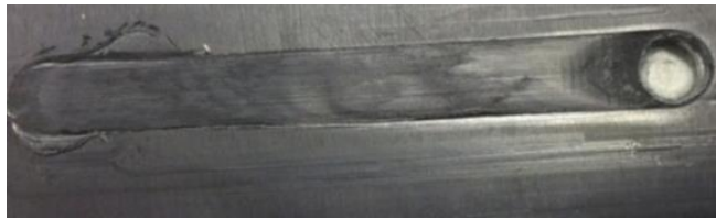
Εικόνα 2.19: Στα δεξιά της εικόνας παρατηρείται η οπή που δημιουργείται λόγω του πείρου στο τέλος της συγκόλλησης [16]
