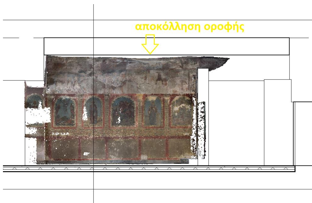
Εικόνα 6.19: Τομή του Βόρειου τοίχου όπου εμφανίζεται αποκόλληση της οροφής.
