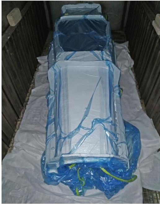
Εικόνα 113. Τοποθέτηση του θηλικού καλούπιού στον ειδικό φούρνο για τη διαδικασία της θερμοσκλήρυνσης
