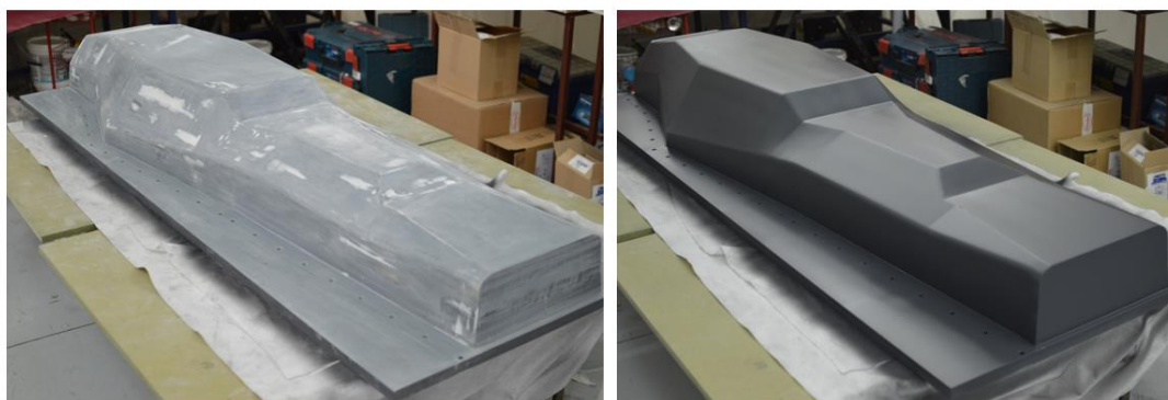
Εικόνα 99. Επιδιόρθωση και βαφή αρσενικών καλουπιών
