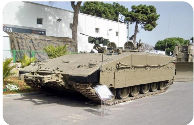
Εικόνα 8. Ισραηλίτικο RCWS σε τεθωρακισμένο όχημα μάχης
