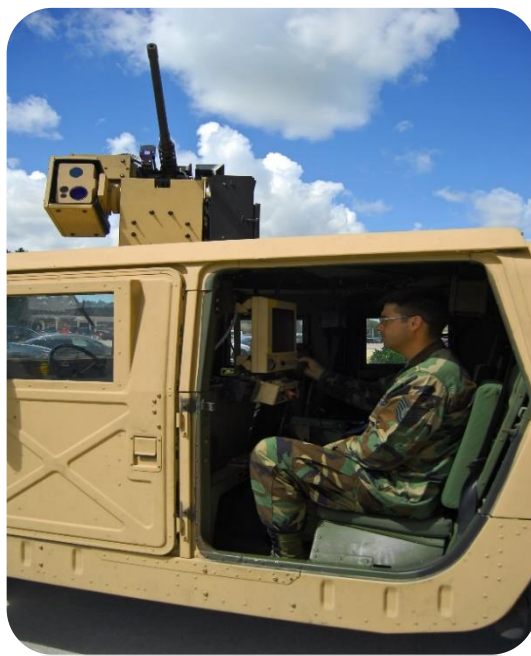
Εικόνα 2. Σταθμός ελέγχου RCWS
