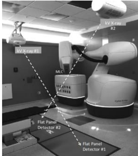
εικόνα 4: Απεικόνιση του πιο πρόσφατου ρομποτικού συστήματος CyberKnife® M6TM με το τριτογενές σύστημα MLC συνδεδεμένο στη θύρα εξόδου δέσμης. Η ταχεία δισδιάστατη στερεοσκοπική απεικόνιση επιτυγχάνεται από ένα ζεύγος εικόνων ακτίνων X στο δωμάτιο, όπως φαίνεται. [5]
