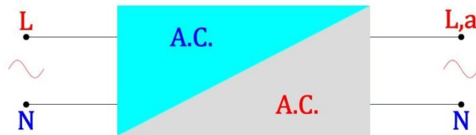
(Σχήμα 1.2.2.1 μπλοκ διάγραμμα μετατροπέα AC/AC)
