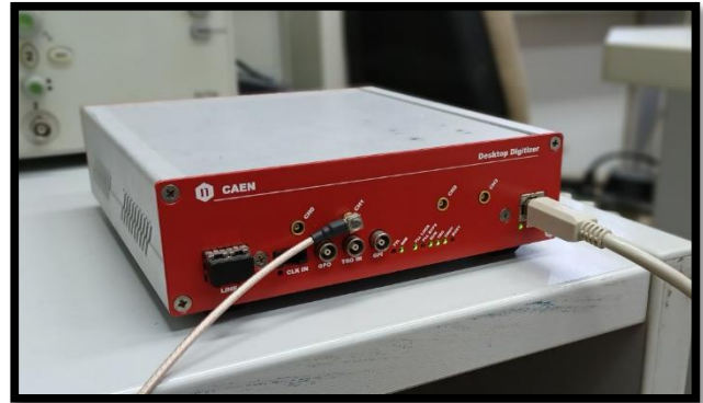
Σχήμα 3.19: Πειραματική διάταξη. Διακρίνεται το σήμα από την έξοδο του ενισχυτή, όπως αυτό εμφανίζεται στον αναλογικό παλμογράφο(αριστερά) και ο τετρακάναλος ψηφιοποιητής DT5720 της εταιρίας CAEN (δεξιά).
