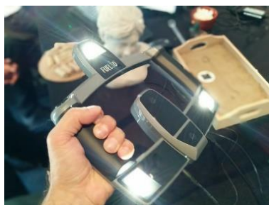
Σάρωση και ψηφιοποίηση αγάλματος Πηγή: "The Fuel3D handheld 3D scanner!" by Creative Tools is licensed under CC BY 2.0
