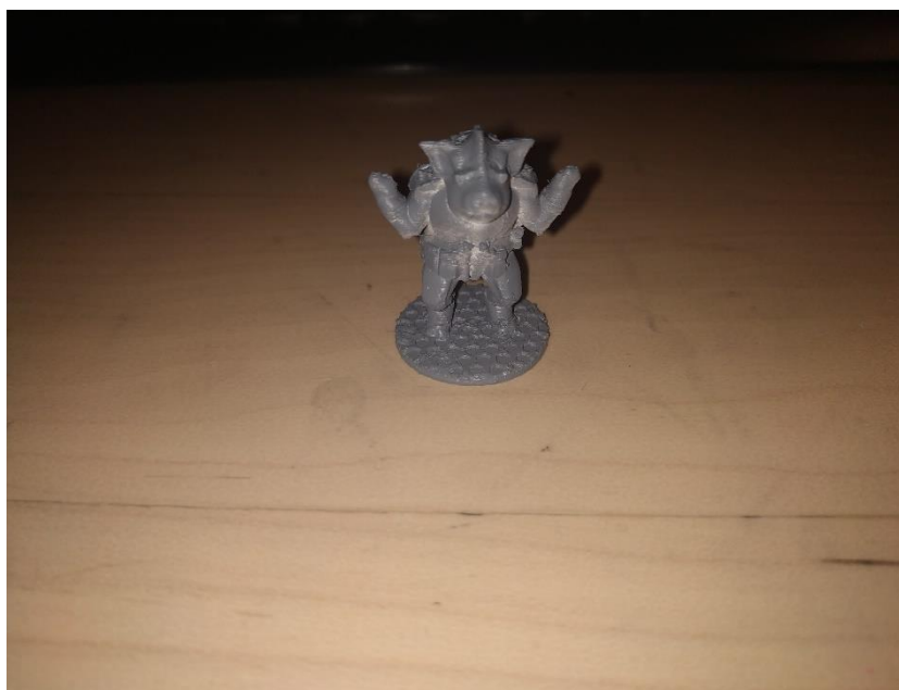
Νίκος Αρβανιτέλλης, πιόνι επιτραπέζιου παιχνιδιού. Τυπώθηκε σε έναν Creality Ender-3 Pro τρισδιάστατο εκτυπωτή χρησιμοποιώντας νήμα PLA.
