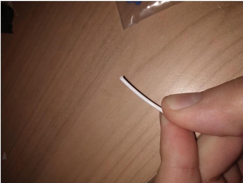
Σπασμένο νήμα. Η πίεση από τα γρανάζια είναι προφανής, καθώς, υπό κανονικές συνθήκες, το νήμα δεν θα είχε τα σημάδια.
