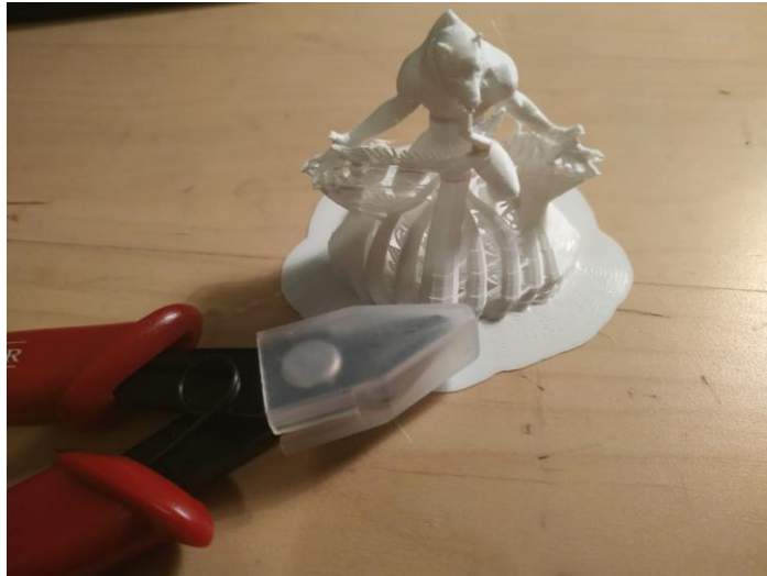
Το εκτυπωμένο μοντέλο και ο κόφτης που χρησιμοποιήθηκε στην αφαίρεση των στηριγμάτων
