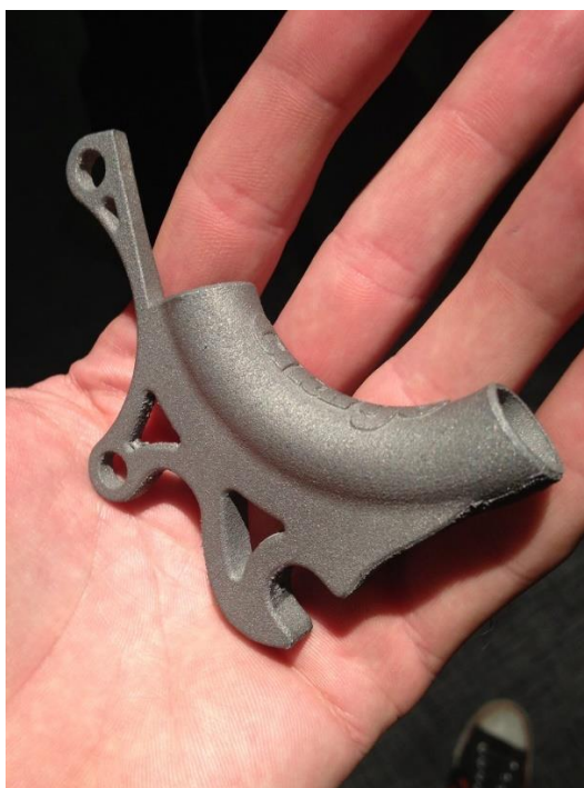
Εκτυπωμένο χερούλι ποδήλατου από τιτάνιο. Πηγή: "3D printed titanium bike part from @chargebikes, a rear dropout, amazingly light and strong" by GavinBell is licensed under CC BY-NC-ND 2.0
