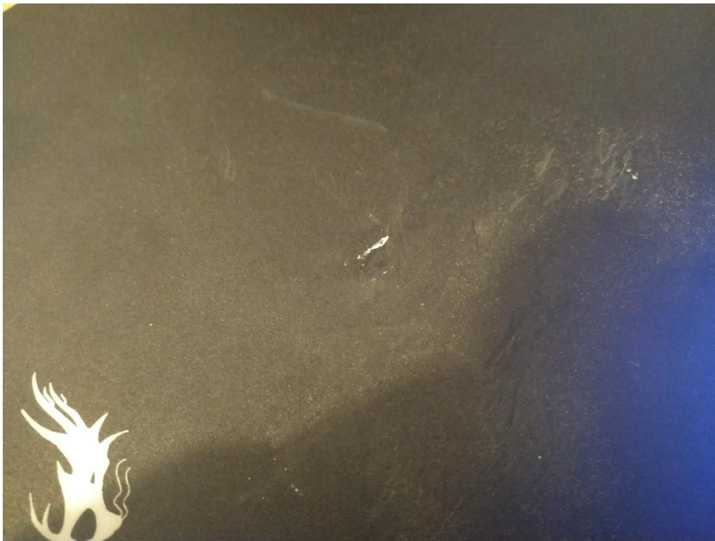
Αποτέλεσμα επαφής στομίου με πλάκα κατασκευής – υλικό έχει κολλήσει στην πλάκα κατασκευή.
