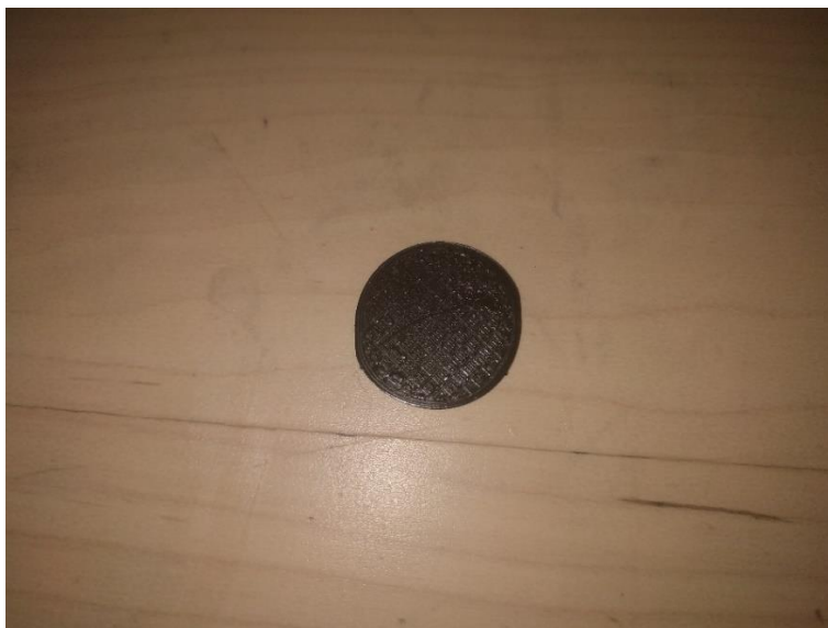
Αποτέλεσμα Under-Extrusion κατά την εκτύπωση κυκλικών βάσεων.
