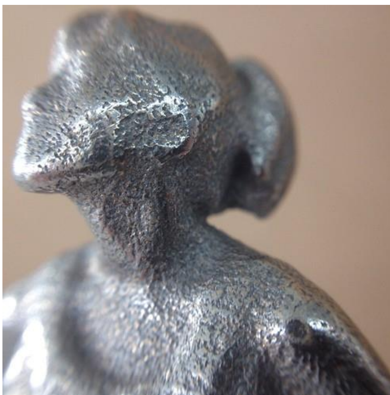
Ανοξείδωτο Ατσάλινο Αγαλματίδιο. Πηγή: "Macro shot of Stainless Steel 3D print from 3D scan." by Shapeways: is licensed under CC BY-NC-ND 2.0
