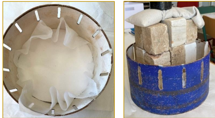
Εικ. 187: Αποκατάσταση της κυρτότητας στη βάση του κυλίνδρου. Φωτ.: Στ. Βαζελάκη.
