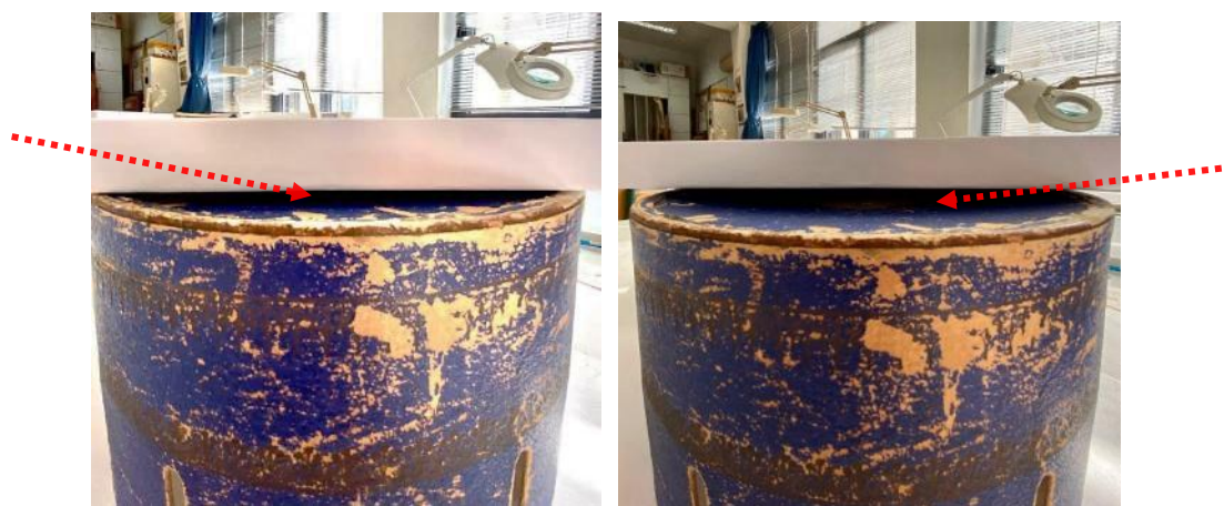
Εικ. 70: Το ζωοτρόπιο με τη βάση του προς τα πάνω. Ακουμπώντας ένα χαρτόνι ευθυγραμμισμένο πάνω από το κατώτερο τμήμα του κυλίνδρου, παρατηρείται πως το τελευταίο δεν ακουμπάει σε όλη την έκταση παρά μόνο στις άκρες, επιβεβαιώνοντας την κοιλότητα της επιφάνειας. Φωτ.: Στ. Βαζελάκη.
