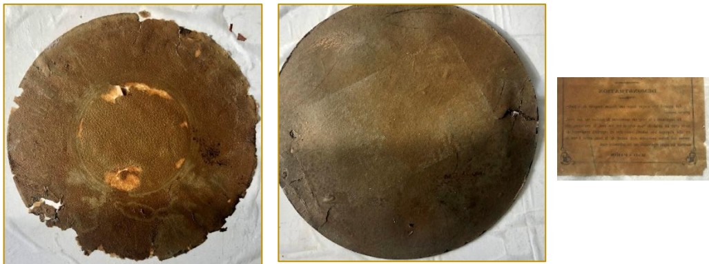
Εικ. 136: Από αριστερά προς τα δεξιά: το μπλε χαρτί, το χαρτόνι και η ετικέτα, μετά τον διαχωρισμό τους από το άνω τμήμα του καλύμματος. Φωτ.: Στ. Βαζελάκη.
