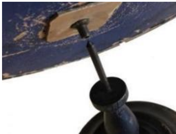
Εικ. 59: Λεπτομέρεια στήριξης-σύνδεσης του κυλίνδρου του ζωοτροπίου στη βάση του με τη βοήθεια μεταλλικού άξονα. Φωτ.: Στ. Βαζελάκη.
