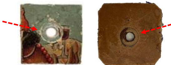
Εικ. 179: Αποτυπώματα από την πίεση των περικοχλίων. Φωτ.: Στ. Βαζελάκη.
