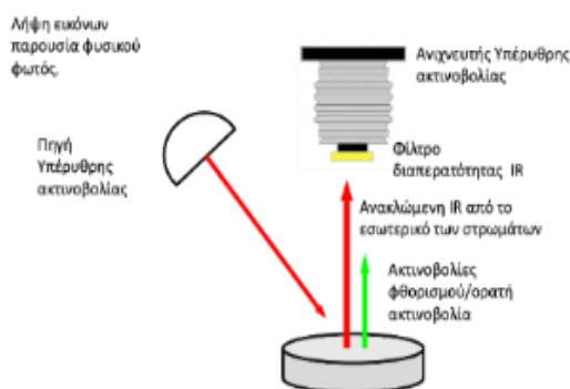
Εικ. 92: Η πειραματική διάταξη IRRef. (Αλεξοπούλου, 2014, p. 8)
