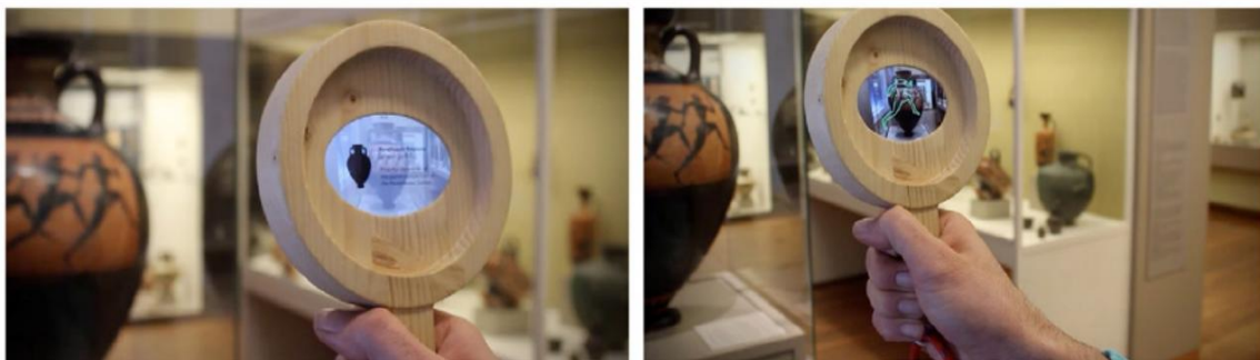
Εικ. 219: «Ενισχυμένος» μεγεθυντικός φακός που αναπτύχθηκε στο πλαίσιο του MESCH Project . (Γιαννούτσου, 2015, p. 244)
