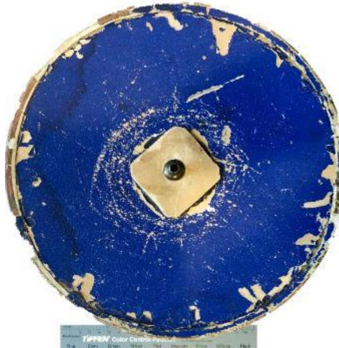
Εικ. 69: Το κάτω τμήμα του κυλίνδρου. Παρουσιάζονται κηλίδες, εκδορές, απώλεια υλικού, μηχανικές καταπονήσεις και μεταγενέστερες επεμβάσεις (τόσο η προσθήκη κόλλας περιμετρικά όσο και η τοποθέτηση χαρτονιού (ύψους 55mm, πλάτους 55mm και πάχους 3mm) στο σημείο σύνδεσης με τον μεταλλικό άξονα). Φωτ.: Στ. Βαζελάκη.
