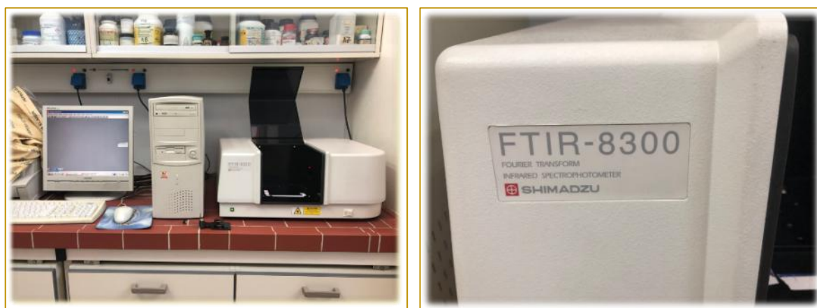
Εικ. 112: Πειραματική διάταξη μεθόδου ανάλυσης FTIR. Φωτ.: Σ. Βαζελάκη
