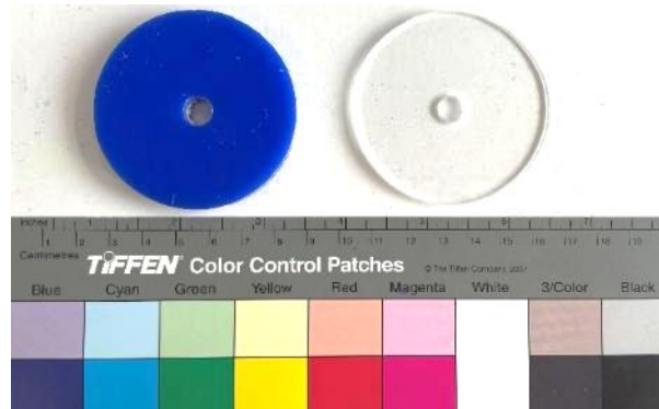
Εικ. 200: Κατασκευές από plexiglas για τη σύνδεση του κυλίνδρου με τη βάση. Φωτ.: Στ. Βαζελάκη.
