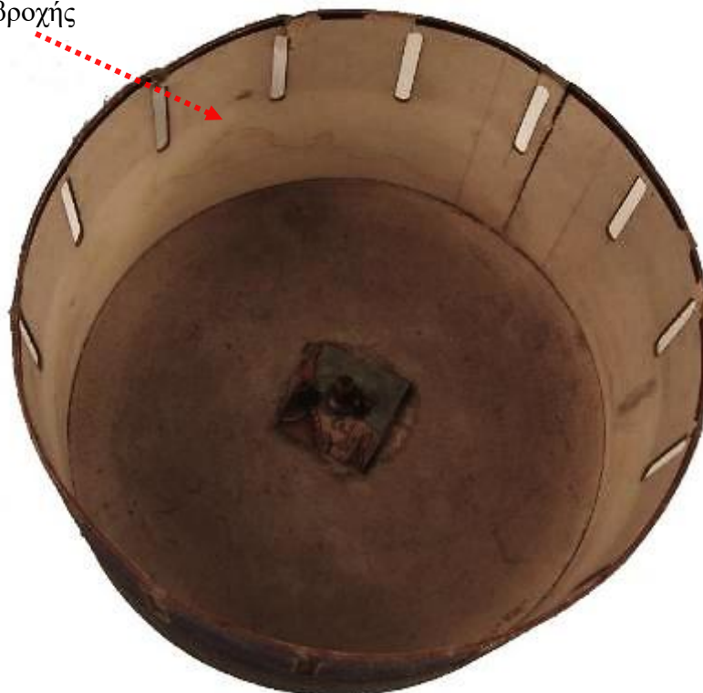
Εικ. 68: Το εσωτερικό του κυλίνδρου του ζωοτροπίου. Παρατηρούνται έντονες επικαθίσεις σκόνης, κηλίδες και μέτωπο διαβροχής, αλλοιώνοντας την αισθητική του. Επίσης, παρατηρείται κατά τη διάρκεια προηγούμενης επέμβασης η προσθήκη τετράγωνου χαρτονιού (ύψους 45mm, πλάτους 45mm και πάχους 3mm) στο κέντρο και ανάμεσα από τους μεταλλικούς συνδέσμους. Φωτ.: Στ. Βαζελάκη.
