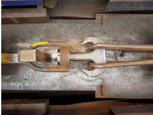
Εικόνα 1. Εκτυπωμένος γάντζος HUISMAN από WAAM με ικανότητα ανύψωσης έως 80 τόνους [1]
