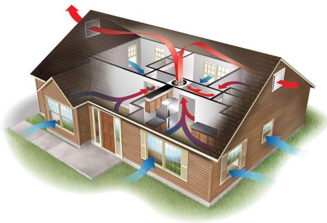
Εικόνα 20: Απεικόνιση πορείας φυσικού αερισμού-δροσισμού.
