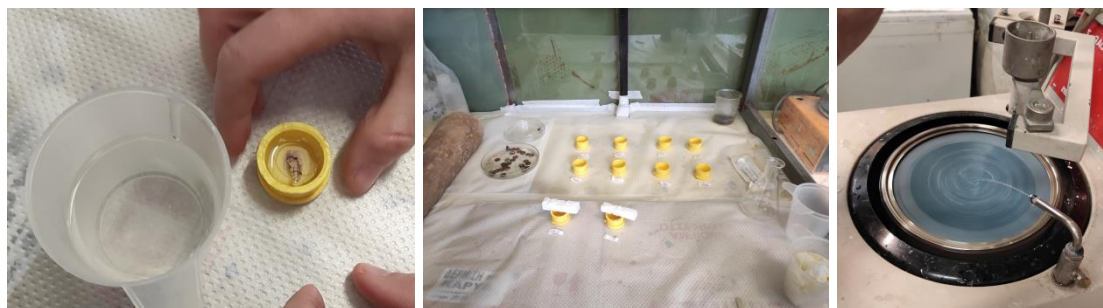
Εικόνα 6. Αριστερά: Εγκιβωτισμός δείγματος, Μέσο: Στερεοποίηση ρητίνης, Δεξιά: Λειαντικός τροχός (Φωτ: Β. Παναγοπούλου) [© ΕΚΕΦΕ, Δημόκριτος].
