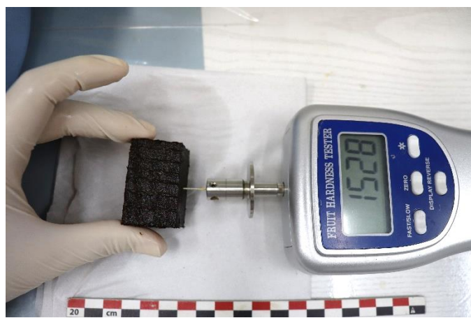
Εικ. 2.23 Εφαρμογή πενετρομέτρησης στα δοκίμια.
