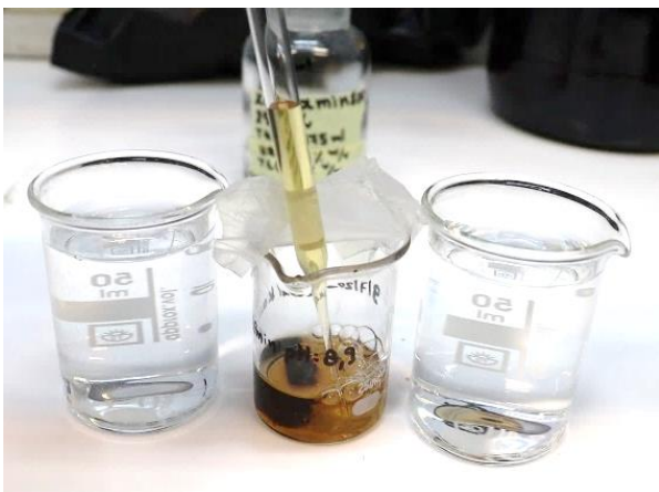
Εικ. 2.29 Διαδικασία λήψης ποσότητας διαλύματος με γυάλινη πιπέτα για την δοκιμή θολερότητας.
