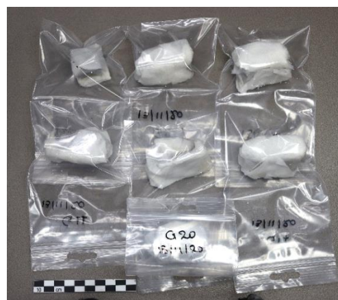
Εικ. 2.59 Δοκίμια κακής κατάστασης διατήρησης κατά την εφαρμογή της μεθόδου μελαμίνης - φορμαλδεΐδης.
