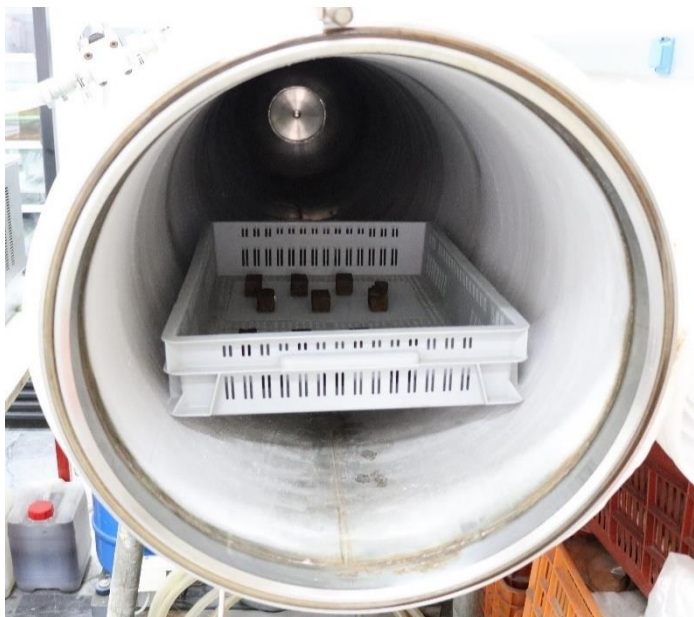
Εικ. 2.64 Τοποθέτηση του τελάρου με τα δοκίμια στον προ-ψυγμένο θάλαμο λυοφιλίωσης.
