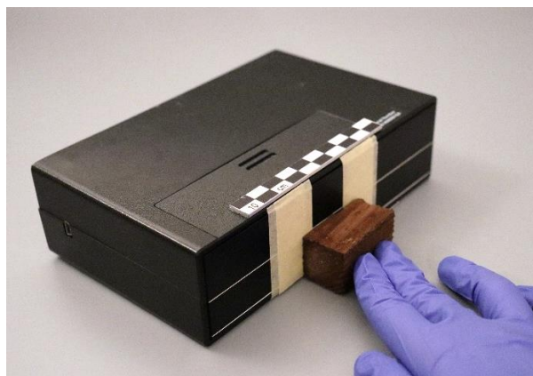
Εικ. 2.70 Μετακίνηση του δοκιμίου για την λήψη τριών μετρήσεων στιλπνότητας.
