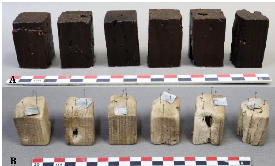
Εικ. 3.20 Δοκίμια κακής κατάστασης διατήρησης πριν (A), και μετά την συντήρηση μελαμίνη - φορμαλδεΐδη (B).
