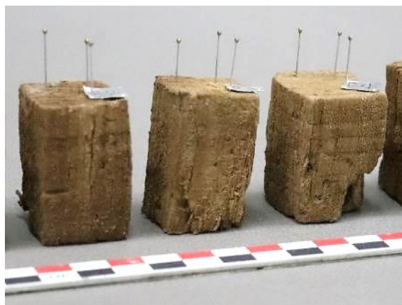
Εικ. 3.28 Επιφάνειες των μαρτύρων (freeze drying) που εμφανίζουν ανομοιογένεια (τραχύτητα).
