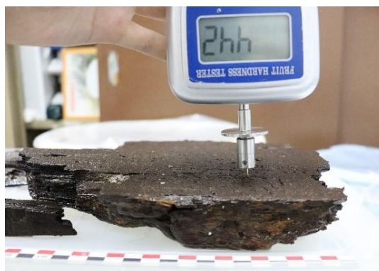
Εικ. 2.44 Πενετρομέτρηση δοκιμίου.
