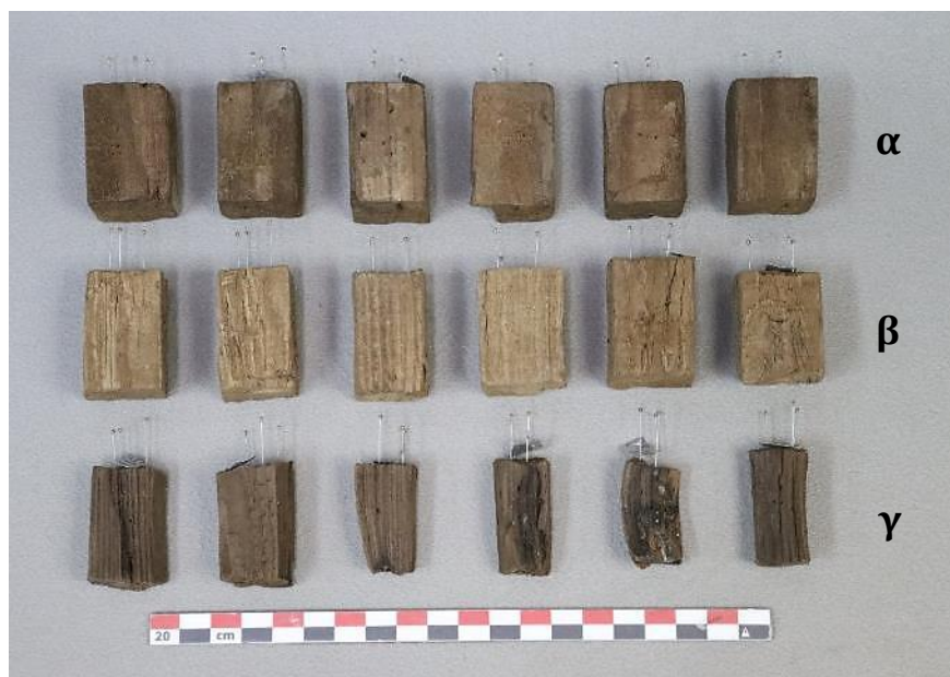
Εικ. 3.24 Χρωματικές διαφορές στην κακή κατάσταση διατήρησης, μεταξύ των συντηρημένων δοκιμίων με PEG και λυοφιλίωση (α), των ήπια αφυδατωμένων δοκιμίων - μάρτυρες λυοφιλίωσης (β), και των μαρτύρων αέρα (γ).
