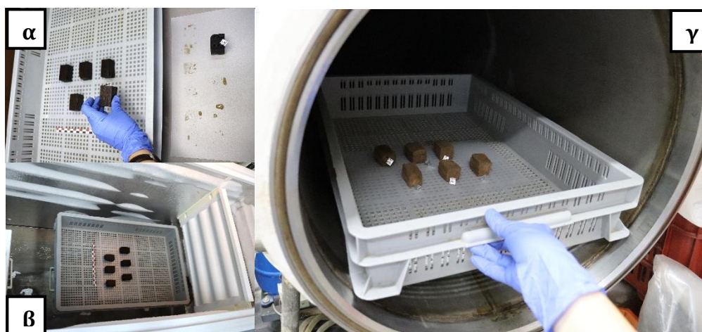
Εικ. 2.66 α) Τοποθέτηση δοκιμίων στο κιβώτιο, β) μεταφορά του κιβωτίου στον καταψύκτη και, γ) τοποθέτηση του κιβωτίου στον θάλαμο λυοφιλίωσης.
