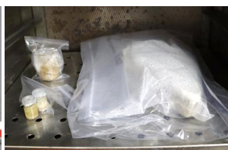
Εικ. 2.54 Παραμονή σφραγισμένου δοκιμίου και γυάλινων δοχείων στο πυριαντήριο.
