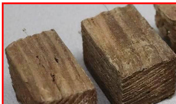
Εικ. 3.30 Λεπτομέρεια εικόνας 3.29 όπου φαίνεται η τραχύτητα των επιφανειών των δοκιμίων.
