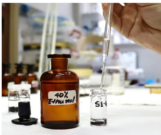
Εικ. 2.9 Αλλαγή του διαλύματος αιθανόλης με την χρήση γυάλινης πιπέτας.
