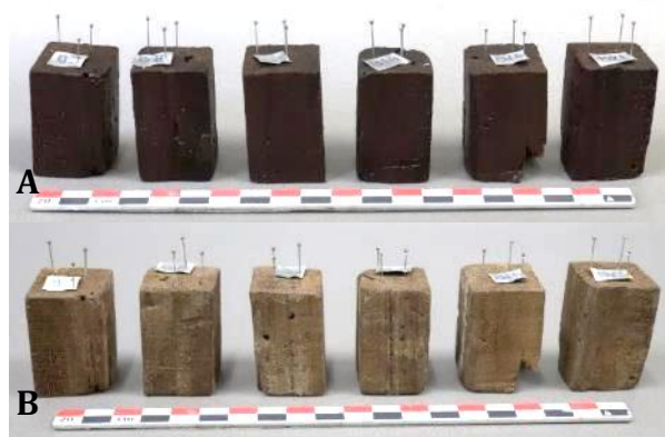
Εικ. 3.17 Δοκίμια κακής κατάστασης διατήρησης ένυδρα (A), και μετά την λυοφιλίωση (B).
