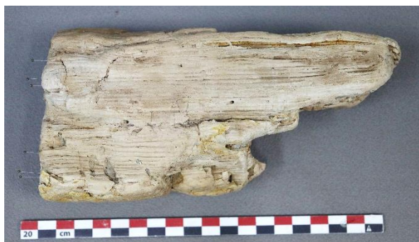
Εικ. 3.22 Δοκίμιο σύνθετου βαθμού αλλοίωσης μετά την συντήρηση με μελαμίνη - φορμαλδεΐδη.
