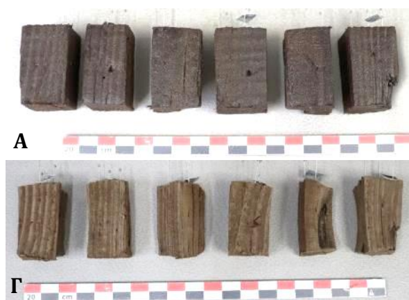
Εικ. 3.18 Μάρτυρες στην ένυδρη κατάσταση (A, B) και μετά από μη ελεγχόμενη ξήρανση στον αέρα (Γ, Δ), καλής και κακής διατήρησης αντίστοιχα.
