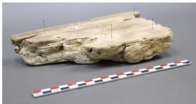
Εικ. 3.22 Δοκίμιο σύνθετου βαθμού αλλοίωσης μετά την συντήρηση με μελαμίνη - φορμαλδεΐδη.
