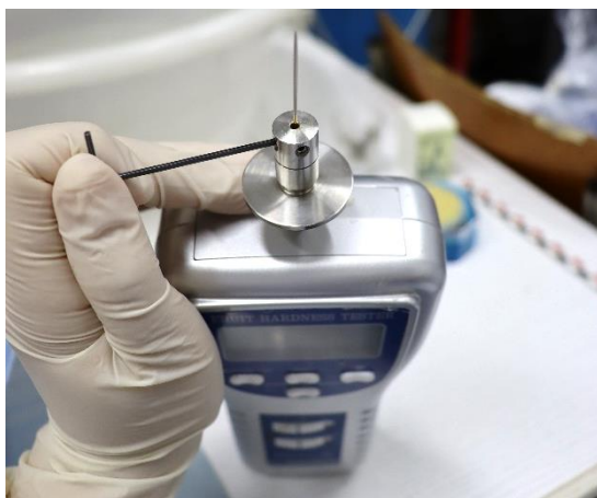
Εικ. 2.22 Προσάρτηση βελόνας ραπτικής στο ακροφύσιο του πενετρόμετρου φρούτων.
