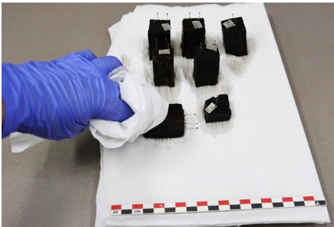
Εικ. 2.61 Καθαρισμός επιφάνειας δοκιμίων από τυχόν περίσσεια διαλύματος PEG.
