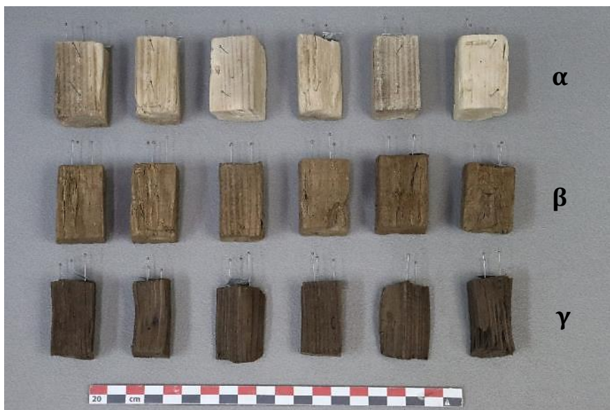
Εικ. 3.25 Χρωματικές διαφορές στην καλή κατάσταση διατήρησης, μεταξύ των συντηρημένων δοκιμίων με μελαμίνη – φορμαλδεΰδη (α), των ήπια αφυδατωμένων δοκιμίων / μάρτυρες λυοφιλίωσης (β), και των μαρτύρων αέρα (γ).
