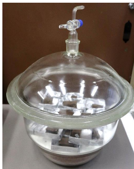
Εικ. 2.17 Παραμονή δοκιμίων σε ξηραντήρα με silica gel.
