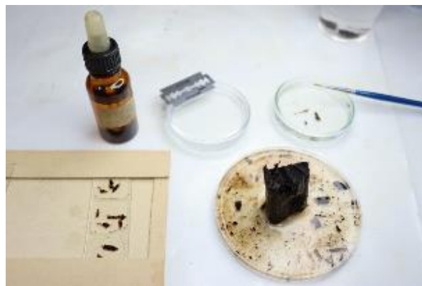
Εικ. 2.5 Τοποθέτηση τομών σε αντικειμενοφόρες πλάκες.
