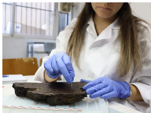
Εικ. 2.40 Εφαρμογή του «pin-testing»
