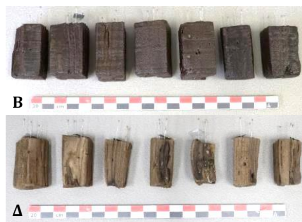
Εικ. 3.18 Μάρτυρες στην ένυδρη κατάσταση (A, B) και μετά από μη ελεγχόμενη ξήρανση στον αέρα (Γ, Δ), καλής και κακής διατήρησης αντίστοιχα.
