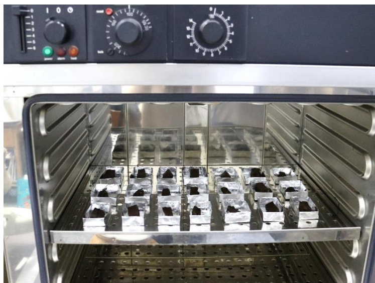
Εικ. 2.16 Ξήρανση δοκιμίων στο πυριαντήριο.
