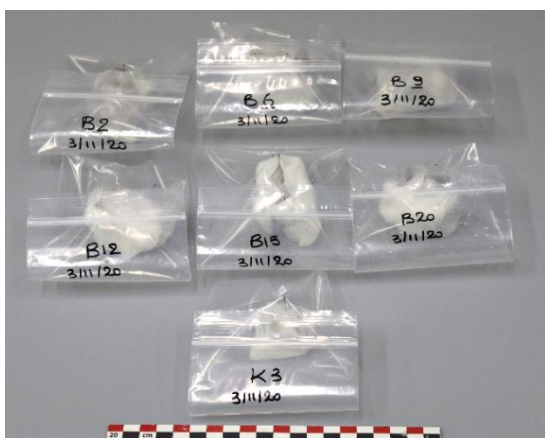
Εικ. 2.58 Δοκίμια καλής κατάστασης διατήρησης κατά την εφαρμογή της μεθόδου μελαμίνης - φορμαλδεΐδης.
