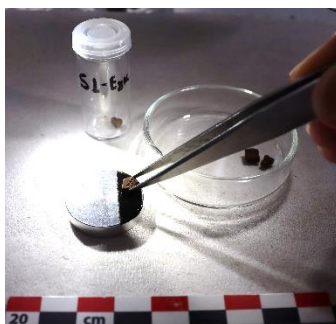
Εικ. 2.12 Επικόλληση τομών σε δειγματοφορέα αλουμινίου.
