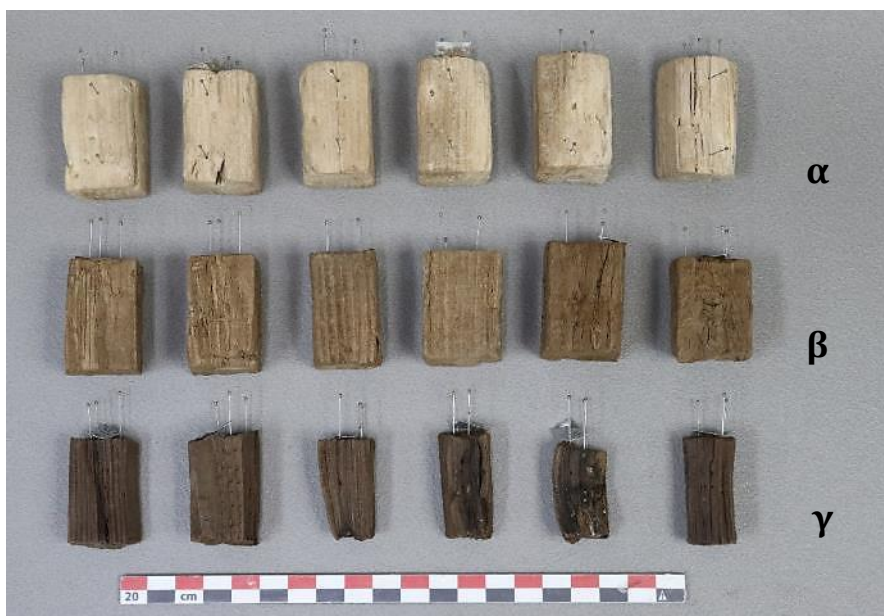
Εικ. 3.26 Χρωματικές διαφορές στην κακή κατάσταση διατήρησης, μεταξύ των συντηρημένων δοκιμίων με μελαμίνη – φορμαλδεΰδη (α), των ήπια αφυδατωμένων δοκιμίων / μάρτυρες λυοφιλίωσης (β), και των μαρτύρων αέρα (γ).
