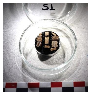
Εικ. 2.13 Τομές από το δείγμα S1 επικολλημένες σε stub.
