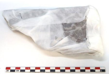
Εικ. 2.51 Περιτύλιξη του δοκιμίου με διαβρεγμένο απορροφητικό οικιακό χαρτί.
