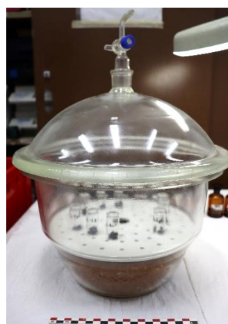
Εικ. 2.10 Παραμονή των δειγμάτων σε γυάλινο ξηραντήρα με silica gel.
