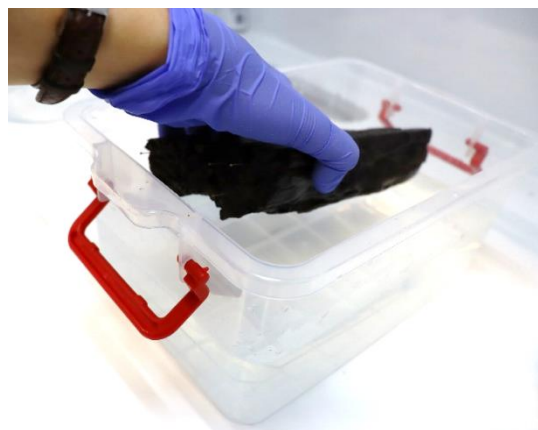
Εικ. 2.46 Τοποθέτηση τμήματος ξύλου σύνθετης κατάστασης διατήρησης στο διάλυμα μελαμίνης – φορμαλδεΰδης.
