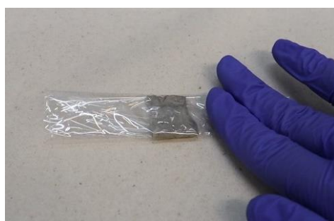
Εικ. 2.32 Κάλυψη του περιτυλιγμένου δοκιμίου με μεμβράνη για την αποφυγή εξάτμισης της υγρασίας.
