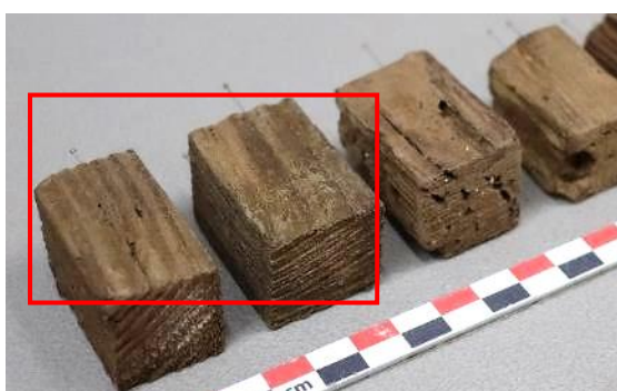
Εικ. 3.29 Επιφανειακές ανομοιογένειες στα συντηρημένα δοκίμια με PEG και λυοφιλίωση της κακής κατάστασης διατήρησης.
