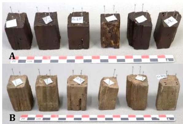
Εικ. 3.16 Δοκίμια καλής κατάστασης διατήρησης ένυδρα (A), και μετά την λυοφιλίωση (B).
