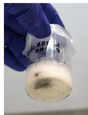
Εικ. 2.28 Ενσωμάτωση ξύλου στο λευκό ίζημα του διαλύματος με οξικό οξύ 1.5% v/v.
