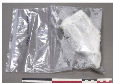
Εικ. 2.55 Υγρασία παγιδευμένη στην αυτόκλειστη σακούλα με μορφή υδρατμών.
