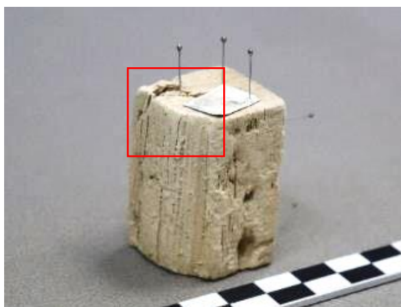
Εικ. 3.21 Δοκίμιο καλής κατάστασης διατήρησης μετά την μελαμίνη - φορμαλδεΐδη.
