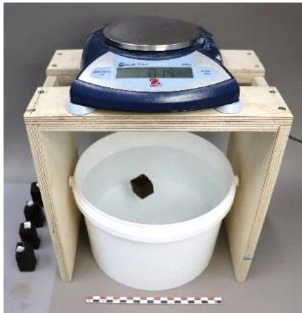
Εικ. 2.18 Υπολογισμός βάρους με βύθιση στο νερό.
