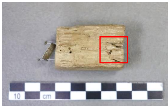
Εικ. 3.31 Επιφάνεια δοκιμίου έπειτα από συντήρηση με μελαμίνη – φορμαλδεΰδη με σημεία με υψηλή στιλπνότητα.
