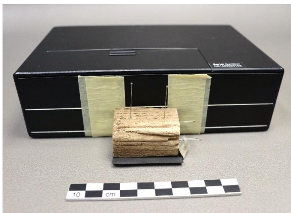
Εικ. 2.69 Διατήρηση του δοκιμίου σε σταθερή θέση καθώς εφάπτεται στο όργανο μέτρησης της στιλπνότητας.
