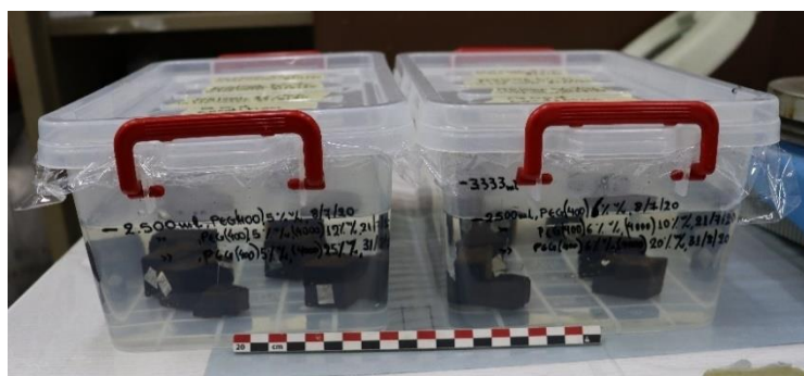
Εικ. 2.60 Τοποθέτηση δοκιμίων στα διαλύματα πολυαιθυλενικής γλυκόλης.
