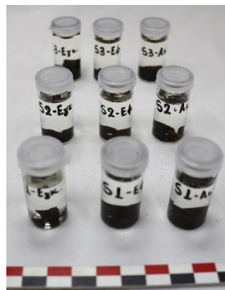
Εικ. 2.7 Τοποθέτηση δειγμάτων σε σφραγισμένα φιαλίδια με νερό βρύσης, ώστε να διατηρηθούν ένυδρα.
