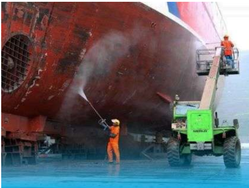
Εικόνα 2. Καθαρισμός γάστρας πλοίου με την μέθοδο της υδροβολής. Πηγή: http://www.dnikolaou.com/images/hathrystithvottur.jpg
