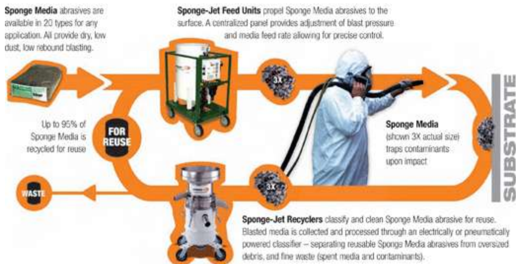
Εικόνα 10. Απεικόνιση της διάταξης του εξοπλισμού της Σπογγοβολής. Πηγή: https://www.spongejet.com/
