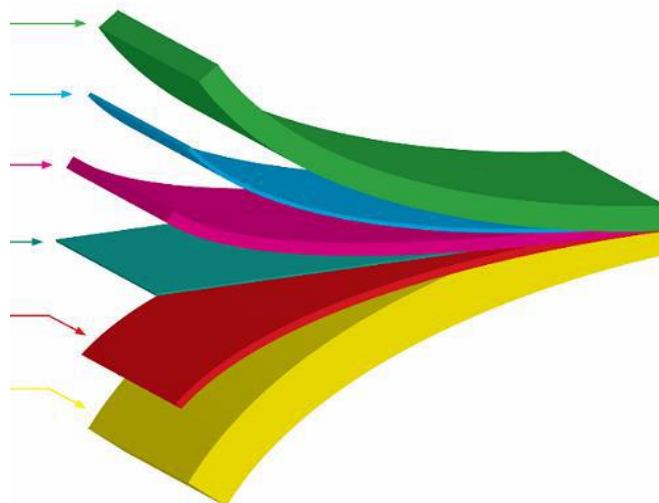
Εικόνα 60. Αναπαράσταση δομής πολυστρωματικού υλικού
