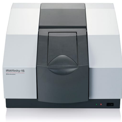
Εικ.6 Φασματοφωτόμετρο FTIR IRAffinity-1S που χρησιμοποιήθηκε για τις ανάγκες της πτυχιακής εργασίας εντός του χώρου του εργαστήριου Σισμανη στο τμήμα οινολογίας στο πανεπιστήμιο Δυτικής Αττικής.
