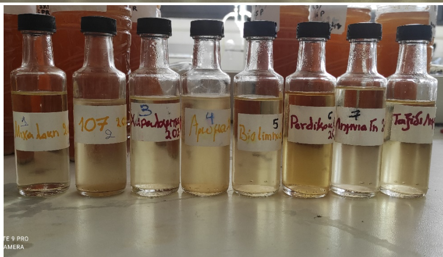
Εικ 9. Αριθμημένα φιαλίδια για τις ανάγκες της ανάλυσης και μετρήσεων στις HPLC
