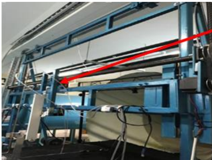
Εικόνα 30 Διαστάσεις κίνησης φορέα. μήκος 140cm, πλάτος 180cm και ύψος 80cm
