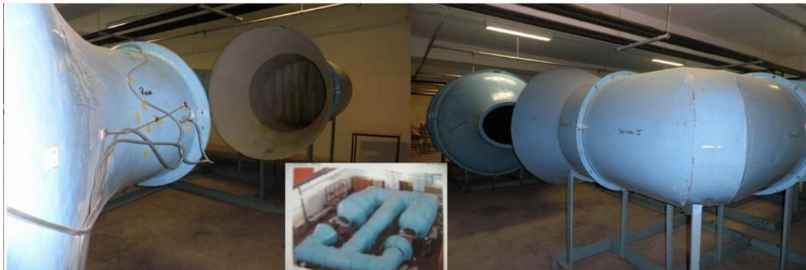
Εικόνα 28 Η αεροσήραγγα του εργαστηρίου αεροδυναμικής του ΠΑ.Δ.Α.
