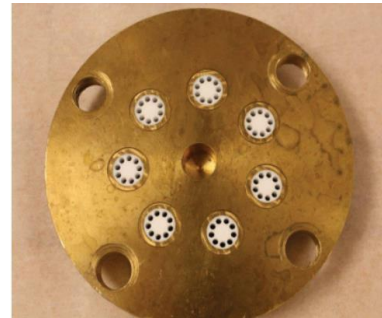
Εικόνα 4.8. Εξωθητήρας για ζυμαρικά μεγάλου μήκους (Long goods).
