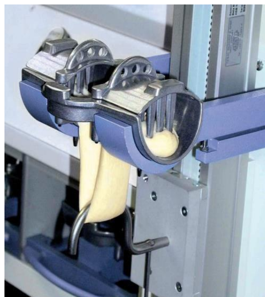
Εικόνα 2.10. Απεικόνιση εξτενσογράφου κατά το τέντωμα του ζυμαριού από το άγκιστρο
