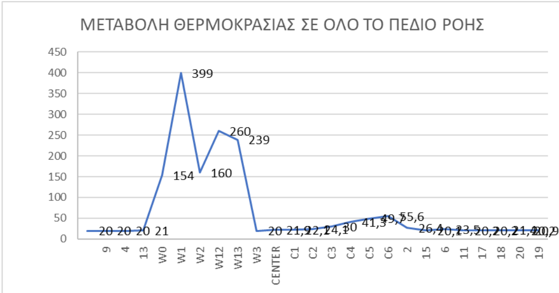
Σχήμα 4-5 Θερμοκρασιακό προφίλ για την περίπτωση έναυσης εστίας φωτιάς στον κλειστό χώρο του αίθριου.
