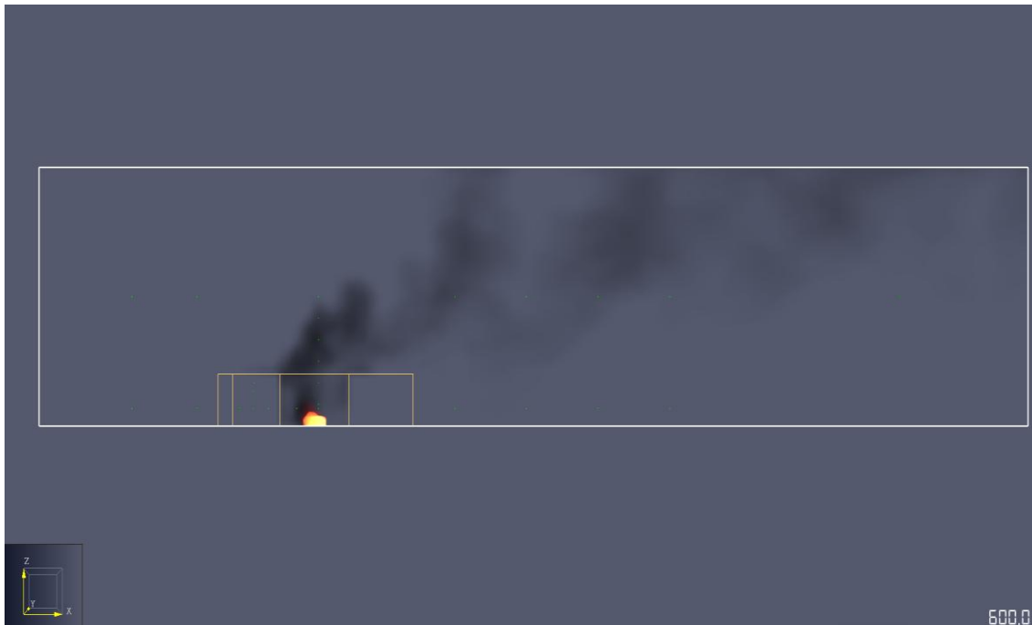
Σχήμα 3-32 Εξέλιξη πλήρωσης καπνού για t=600\text{sec} (παρουσία εστίας φωτιάς στην αυλή)
