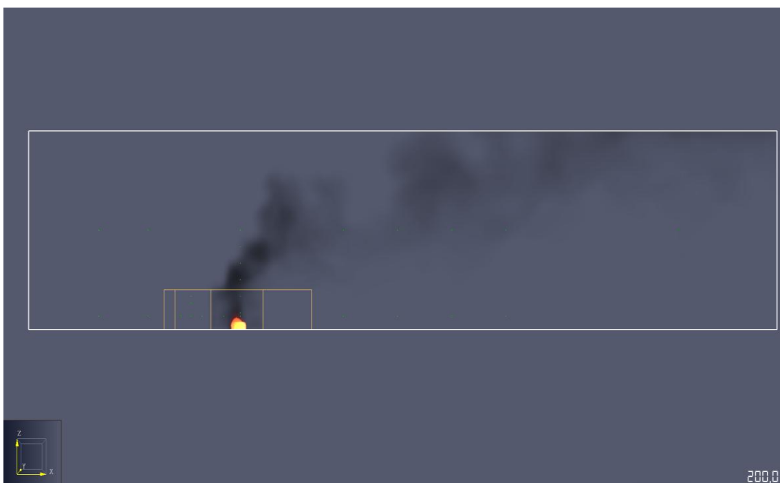
Σχήμα 3-30 Εξέλιξη πλήρωσης καπνού για t=200\text{sec} (παρουσία εστίας φωτιάς στην αυλή).
