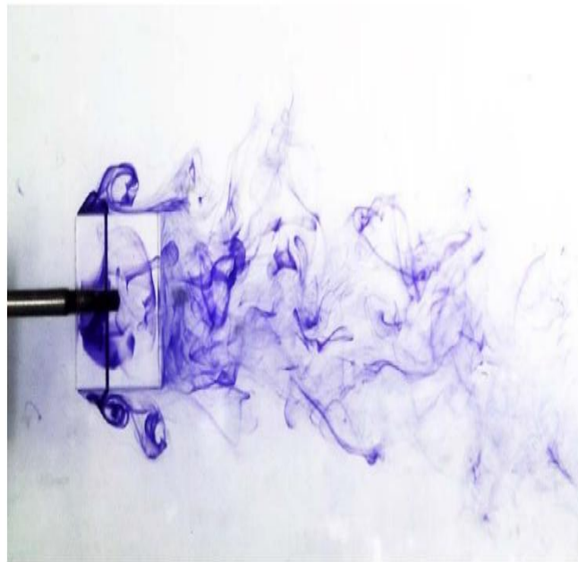
Σχήμα 1-9 Οπτικοποίηση ροής γύρω από τον κύβο με χρήση χρωστικών ουσιών.(Khan, Sooraj et al. 2018).
