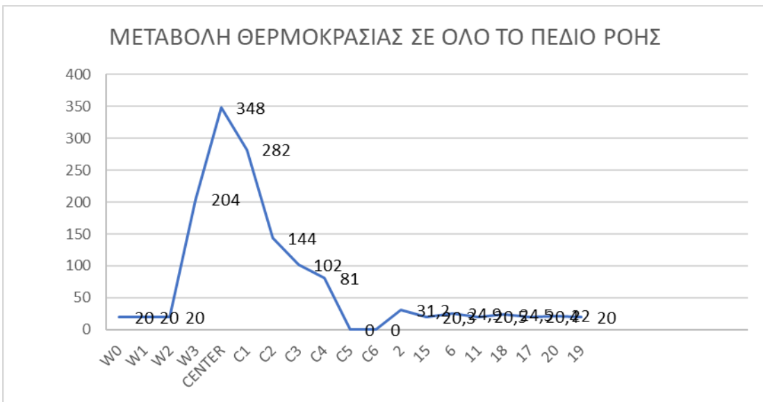
Σχήμα 4-6 Θερμοκρασιακό προφίλ για την περίπτωση έναυσης εστίας φωτιάς στην αυλή του αίθριου.
