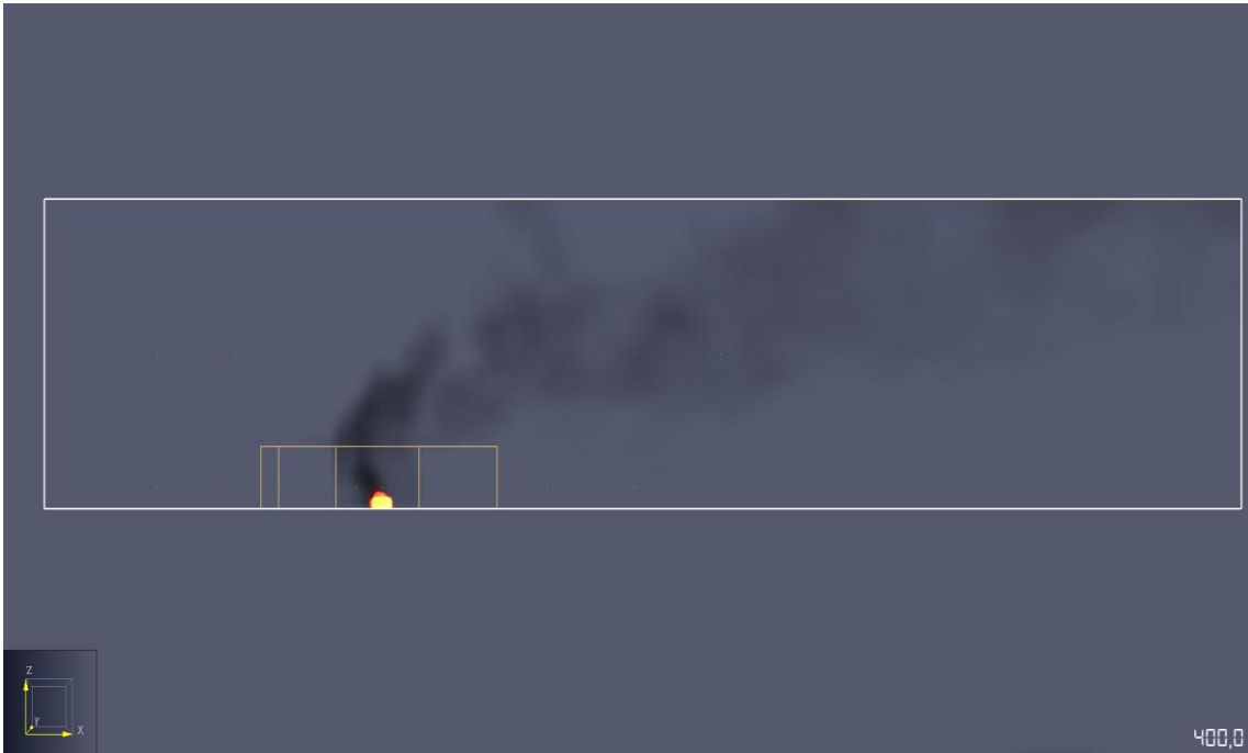
Σχήμα 3-31 Εξέλιξη πλήρωσης καπνού για t=400\text{sec} (παρουσία εστίας φωτιάς στην αυλή).
