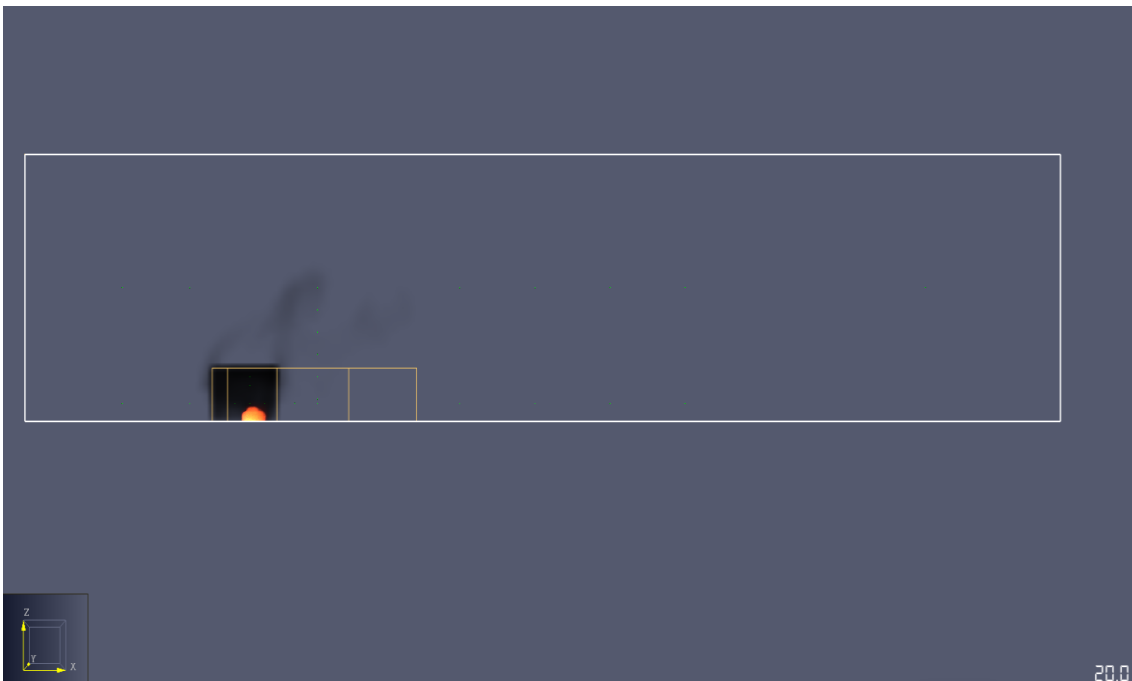
Σχήμα 3-42 Εξέλιξη πλήρωσης καπνού για t=20\text{sec} (παρουσία εστίας φωτιάς εντός του κλειστού χώρου ).
