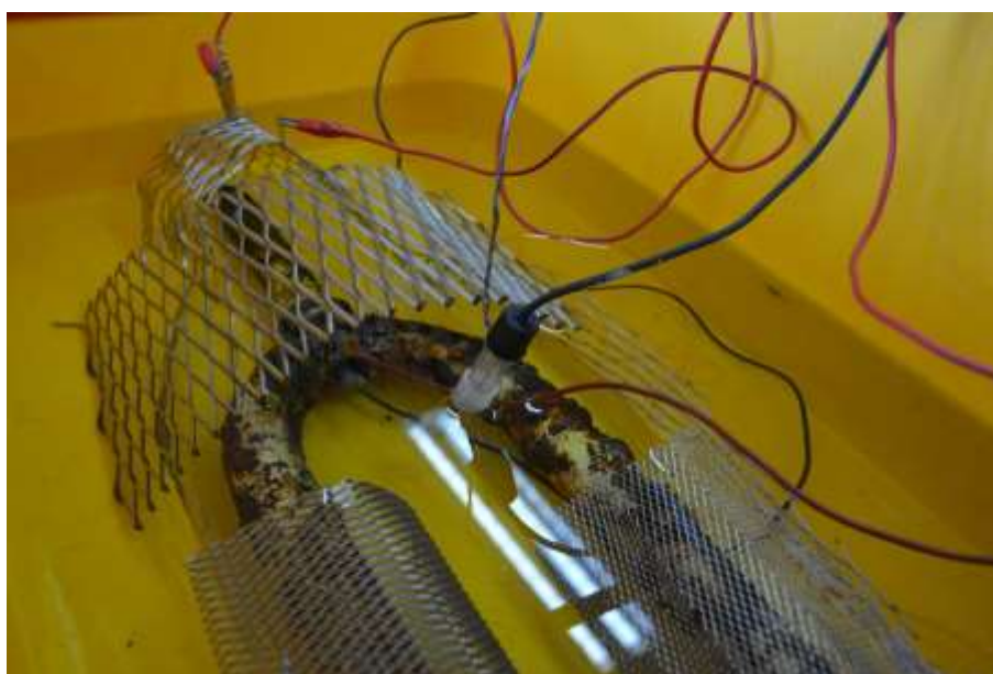
Εικόνα 4 3 Τελική άποψη αντικειμένου στο λουτρό για την ηλεκτρόλυση
