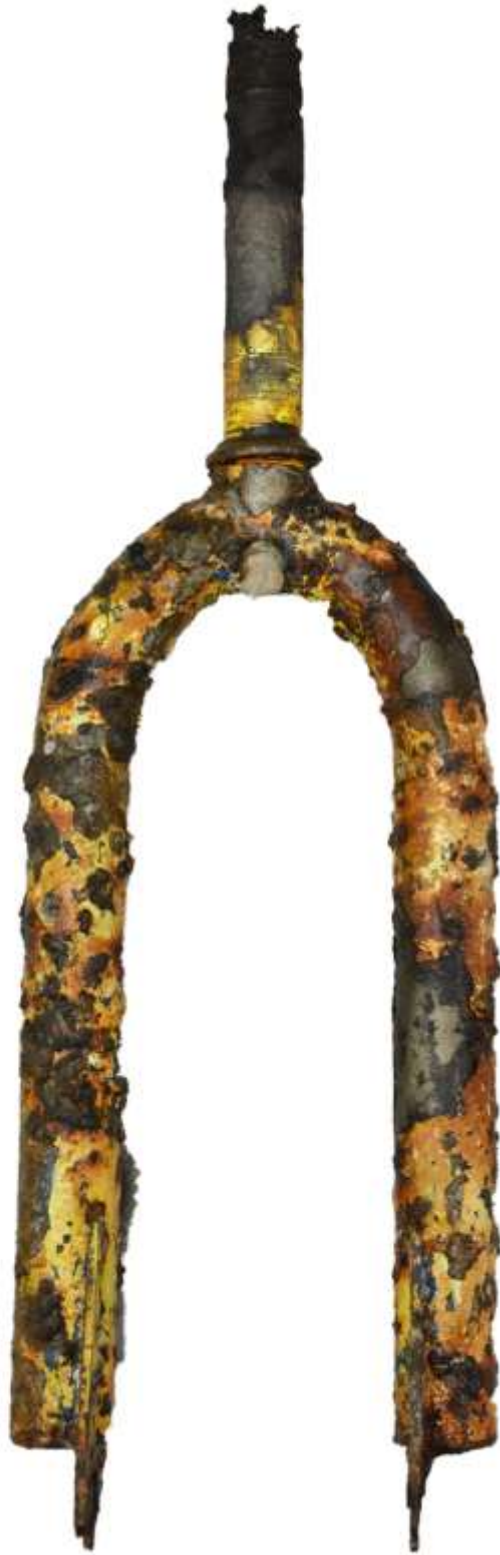
Εικόνα 4.1 Το πιρούνι του ποδηλάτου που θα εφαρμοσθεί η ηλεκτρόλυση
