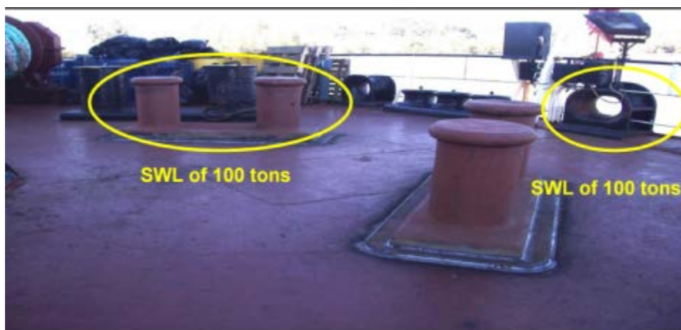
Εικόνα 14: πάνω δεξιά “Deck Chock”, πάνω αριστερά “Bulwark Chock”, στη μέση “Double Chock” και κάτω το “Safe Working Load”
