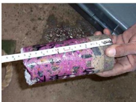
Εικονα : Εφαρμογη διαλυμματος φαινολοφθαλεινης σε πυρηνα
