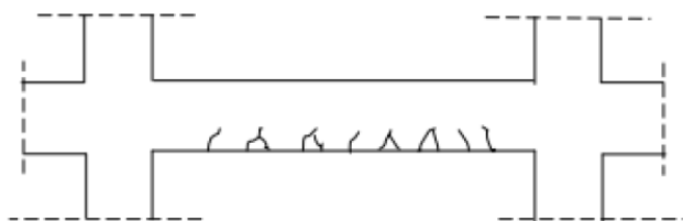
Εικόνα 14 : Καμπτικές ρωγμές στο κάτω πέλμα
