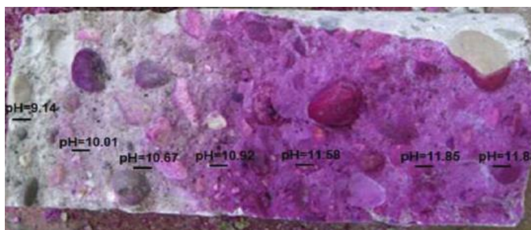
Εικονα : Εφαρμογη διαλυμματος φαινολοφθαλεινης σε πυρηνα
