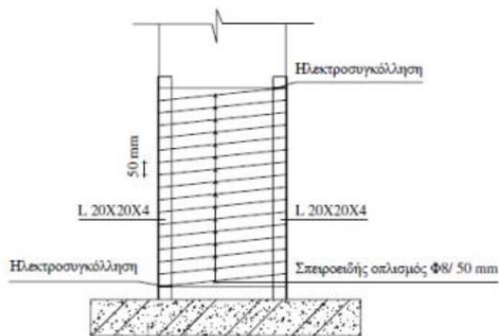
Εικόνα 54 : Περίσφιξη με σπειροειδή οπλισμό
