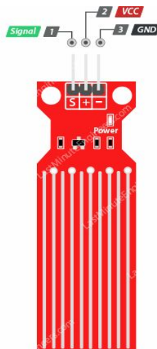
Εικόνα 2.7: Αισθητήριο στάθμης νερού (Πηγή - Ιστοσελίδα: https://lastminuteengineers.com/water-level-sensor-arduino-tutorial/ )
