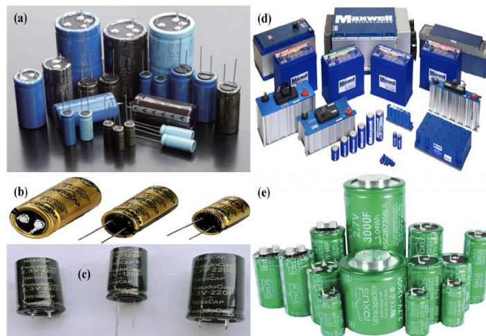
Σχήμα 2.34 Εμπορικοί υπερπυκνωτές ως (α) EDLC, (β) & (γ) Ψευδοπυκνωτές, (δ) & (ε) Υβριδικοί υπερπυκνωτές.
