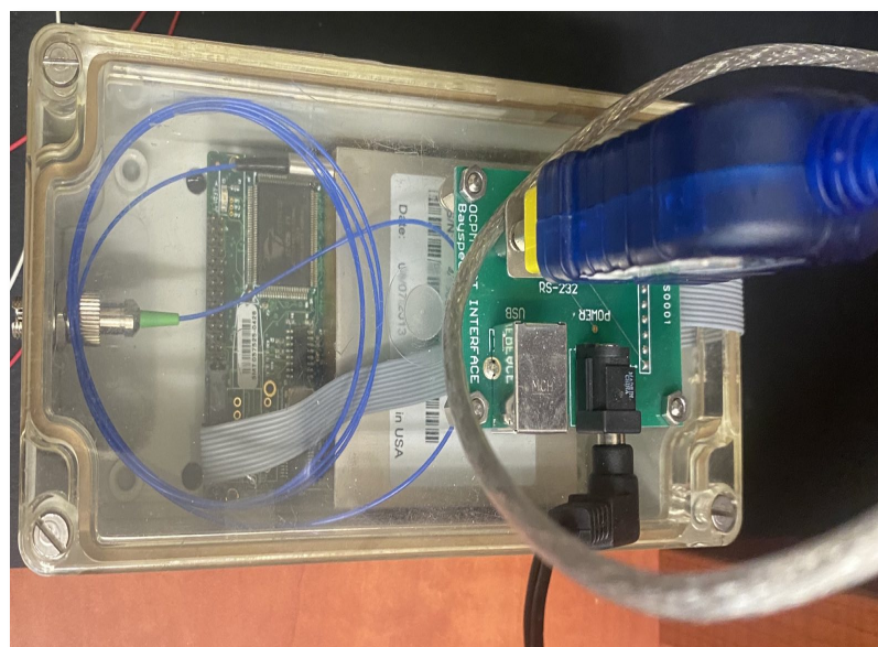
Εικόνα 2.2: Φορητός Οπτικός Φασματικός Αναλυτής (BaySpec)
