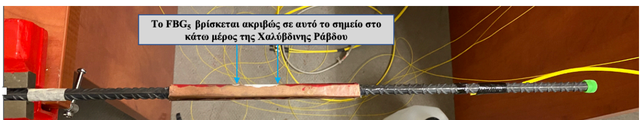
Εικόνα 3.5: Περιστραμμένος 180° οπλισμός σκυροδέματος με το FBG 5 να βλέπει προς τα κάτω
