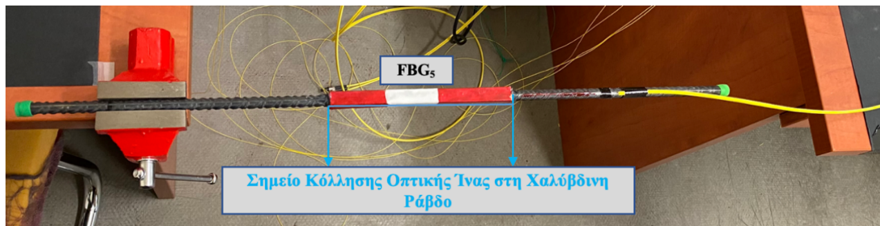
Εικόνα 3.4: Κόλληση FBG 5 σε οπλισμό σκυροδέματος. (Η θέση του αισθητηρίου είναι στο μέσον της λευκής περιοχής και είναι προστατευμένο σε συσκευασία η οποία έχει αντοχή κατά την σκυροδέτηση).
