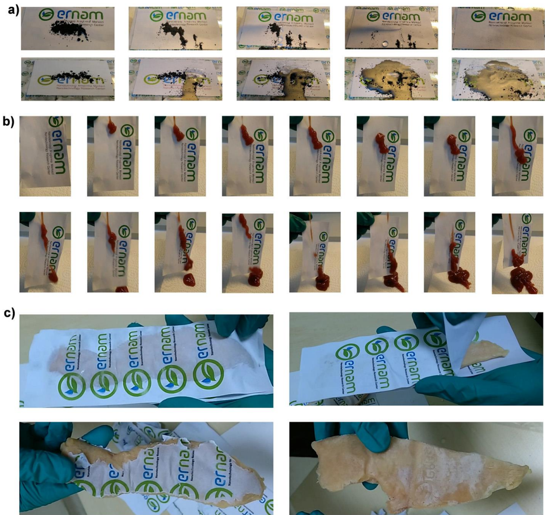
Εικόνα 4.30 Ικανότητα αυτοκαθαρισμού και αντιπαγοποίησης των επικαλύψεων σε χάρτινα υποστρώματα. α) Μια σκόνη γραφίτη χύνεται πάνω από το επικαλυμμένο (πάνω) και μη επικαλυμμένο (κάτω) υπόστρωμα χαρτιού. Κάθε στήλη αντιστοιχεί σε εικόνες που λαμβάνονται μετά από επεξεργασία με 0, 200, 400, 600 και 800 σταγονίδια νερού. β) Στιγμιότυπα που απεικονίζουν την αυτοκαθαριστική ικανότητα της κέτσαπ πάνω από επικαλυμμένο χαρτί, το οποίο είναι κάθετα τοποθετημένο. γ) Εικόνες από ένα στήθος κοτόπουλου τοποθετημένο ανάμεσα σε δύο κομμάτια επικαλυμμένου (δεξιά) και χωρίς επικάλυψη (αριστερά) χαρτί μετά από αποθήκευση σε κατάψυξη για μια εβδομάδα. Οι κάτω εικόνες τραβήχτηκαν μετά την αφαίρεση του χαρτιού από το στήθος κοτόπουλου (Torun and Onses, 2017).
