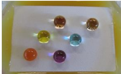
Εικόνα 4.12 Κοινά υγρά προϊόντα τοποθετημένα πάνω σε μια γυάλινη διαφάνεια με επικάλυψη κεριού καρναούμπα (από αριστερά προς τα δεξιά: κάτω σειρά, κέτσαπ και νερό, μεσαία σειρά, πράσινο τσάι Lipton και Gatorade, επάνω σειρά, Coca-Cola και σιρόπι) (Wang et al., 2016).
