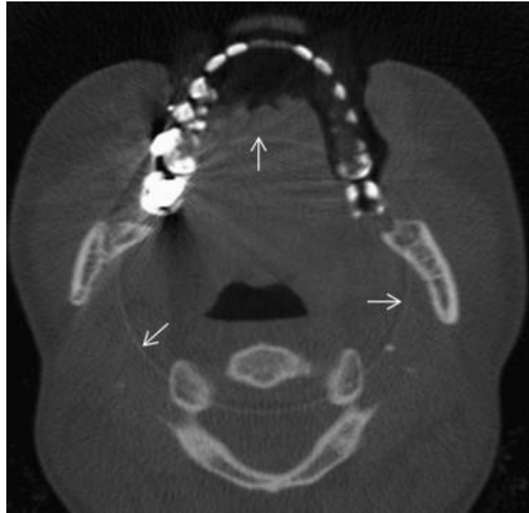
Εικόνα 9: Ring artifact που προκλήθηκε από λανθασμένη βαθμονόμηση (calibration error) (Makins S. R. Σφάλμα! Το αρχείο προέλευσης της αναφοράς δεν βρέθηκε.).
