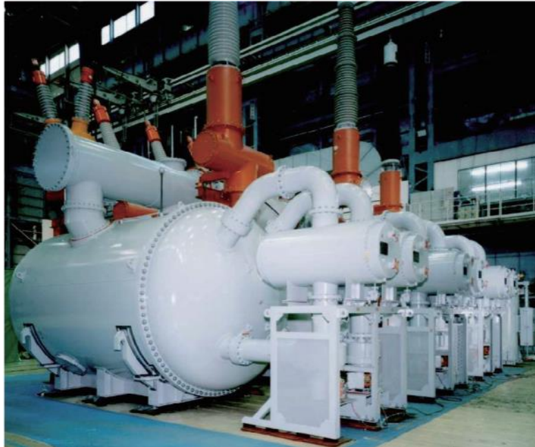
Εικόνα 4. 4. Μετασχηματιστής με χρησιμοποιούμενο ψυκτικό μέσω SF 6 (Gas Immersed Transformers – GITr) της Toshiba [31]
