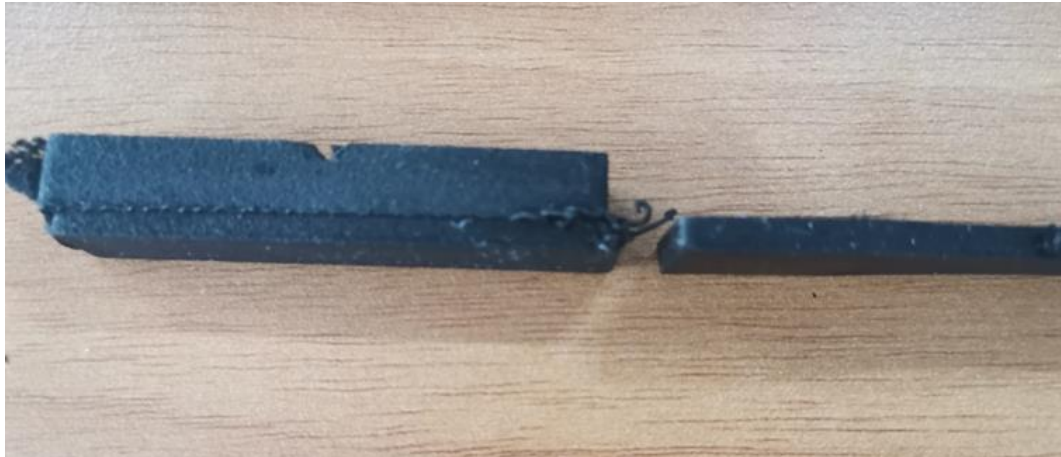
Εικόνα 34: Μετακίνηση στρώσεων κατά την εκτύπωση των δοκιμών κρούσης PAHT CF15
