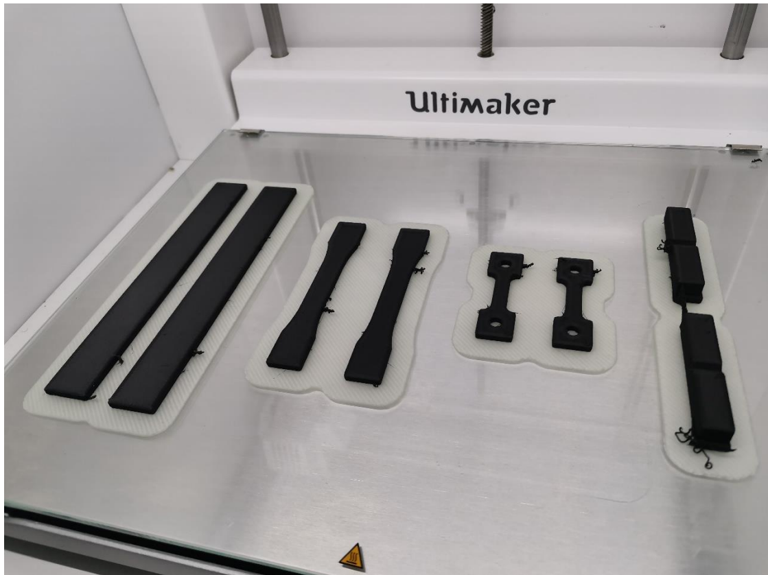
Εικόνα 32: Αποτέλεσμα εκτύπωσης δοκιμίων PAHT CF15
