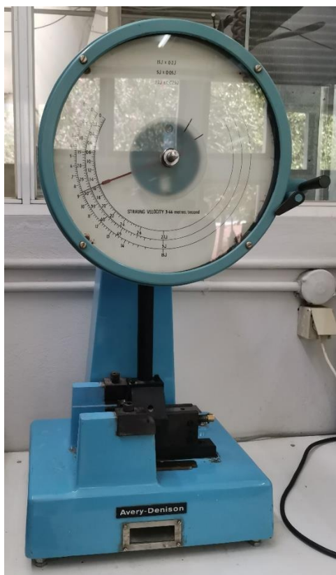
Εικόνα 49: Συσσκευή δοκιμασίας κρούσης κατά Izod στο εργαστήριο της Σχολής Μηχανικών ΠΑΔΑ
