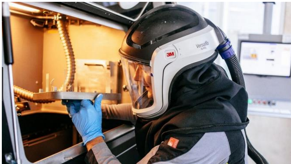
Εικόνα 8: Διάταξη Direct Metal Laser Sintering, Πηγή: https://i.materialise.com/blog/direct-metal-laser-sintering-dml
