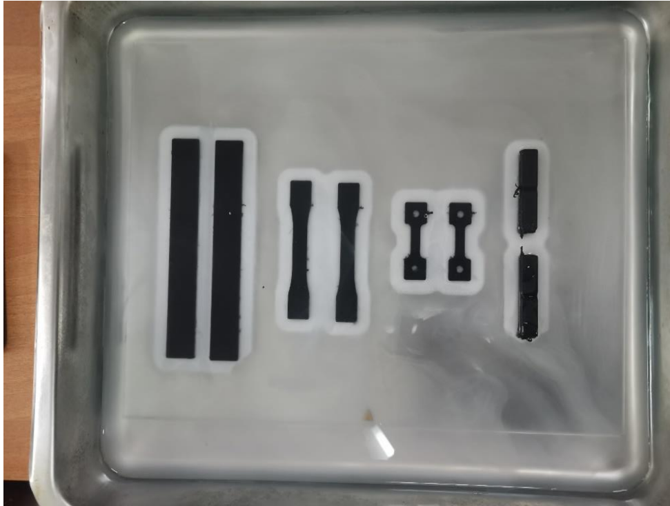
Εικόνα 38: Τοποθέτηση built plate και δοκιμίων σε νερό για τη διάλυση του BVOH
