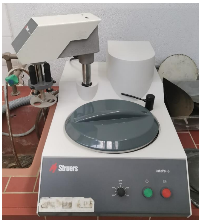
Εικόνα 54: Συσκευή λείανσης Struers LaboPol-5 στο εργαστήριο της Σχολής Μηχανικών ΠΑΑΑ
