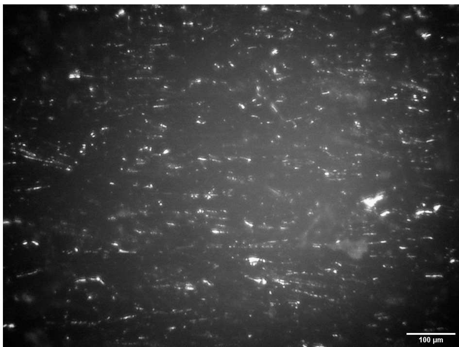
Εικόνα 66: Πλάγια επιφάνεια δοκιμίου RAHT CF15 (X50)
