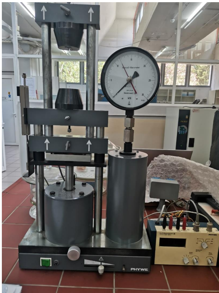
Εικόνα 41: Διάταξη δοκιμασίας εφελκυσμού που χρησιμοποιήθηκε.
