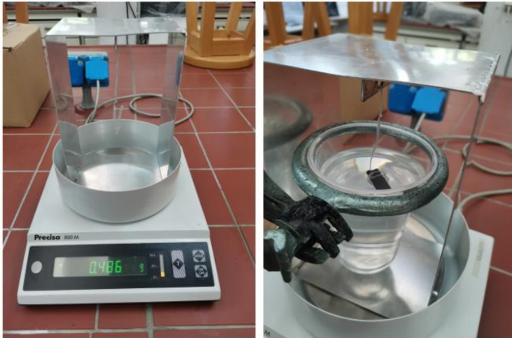
Εικόνα 55: Διαδικασία μέτρησης πυκνότητας δοκιμίων με τη μέθοδο της εμβάπτισης σε υγρό.
