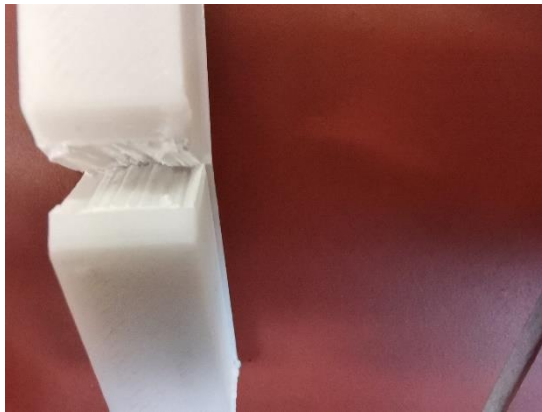
Εικόνα 51: Δοκίμιο PC μετά τη δοκιμασία κρούσης.
