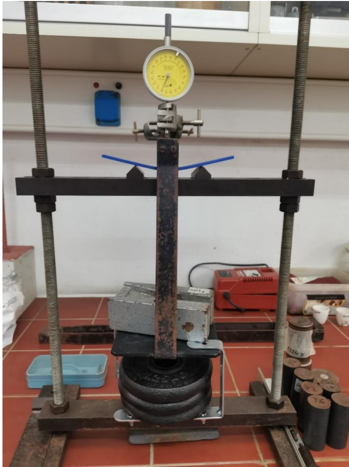
Εικόνα 42: Δοκιμασία κάμψης τριών σημείων σε δοκίμιο PLA στο εργαστήριο της Σχολής Μηχανικών ΠΑΔΑ
