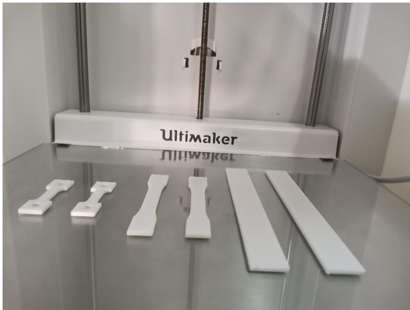
Εικόνα 28: Ολοκλήρωση εκτύπωσης δοκιμίων PC χωρίς raft
