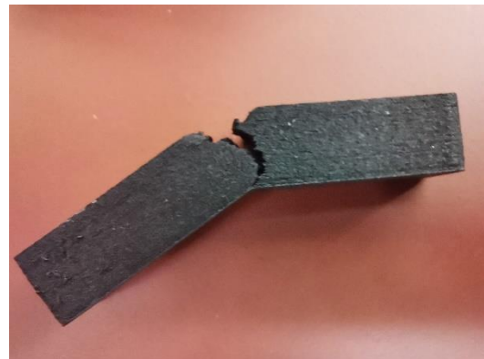
Εικόνα 52: Δοκίμιο PAHT_CF15 μετά τη δοκιμασία κρούσης με εμφανείς αιχμηρές κορυφές.
