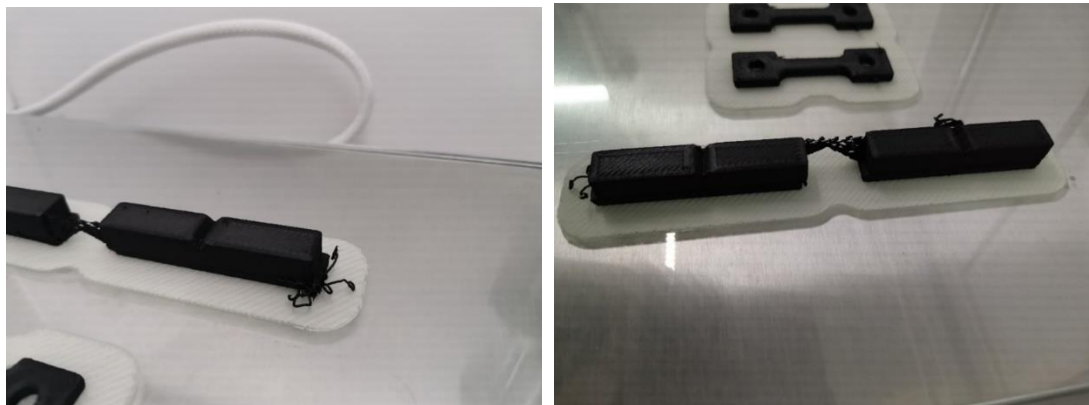
Εικόνα 33: Μετακίνηση στρώσεων κατά την εκτύπωση των δοκιμίων κρούσης PAHT CF15
