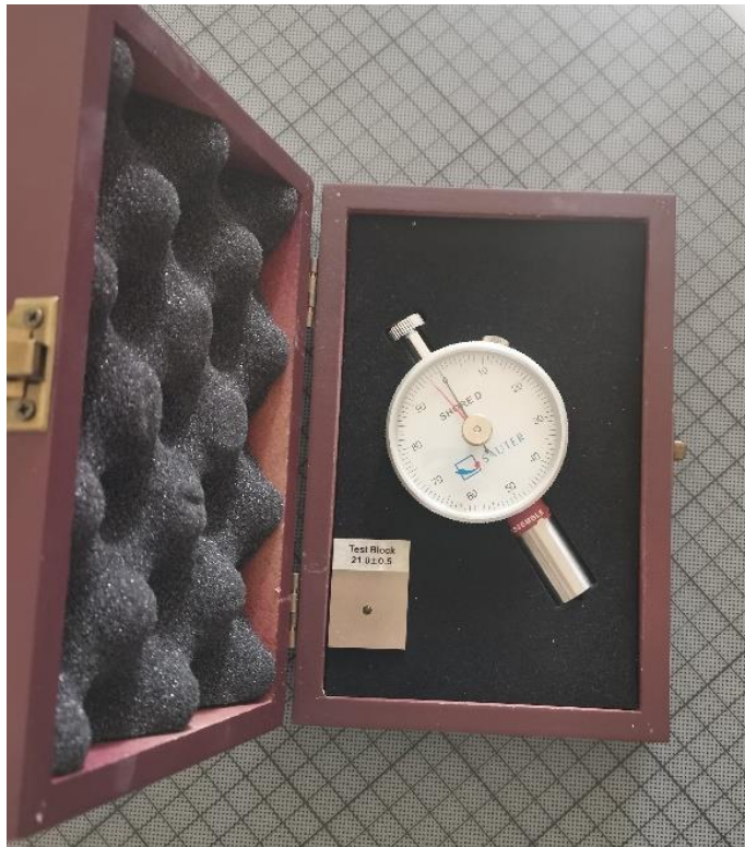
Εικόνα 53: Συσκευή Sauter HBD 100-0HBD 100-0 στο εργαστήριο της Σχολής Μηχανικών ΠΑΔΑ
