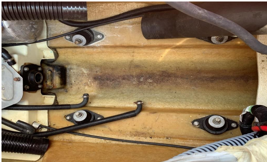
Εικόνα 18 Εναπομείναν χώρος μετά την αφαίρεση του κινητήρα
