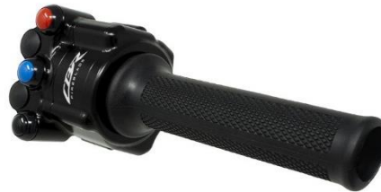
Εικόνα 13 Χειριστήριο επιτάχυνσης περιστροφικό
