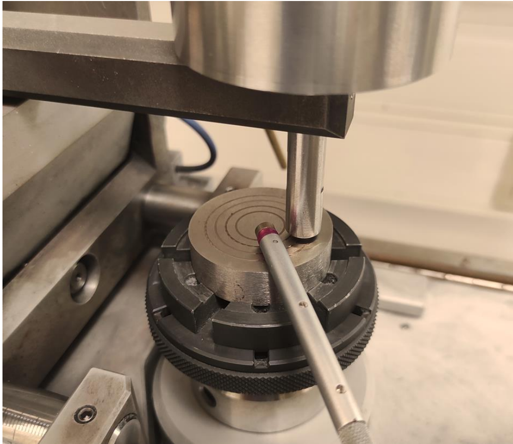
Εικόνα 5.10 Τρόπος λήψης ενδιάμεσης μέτρησης του όγκου φθοράς
