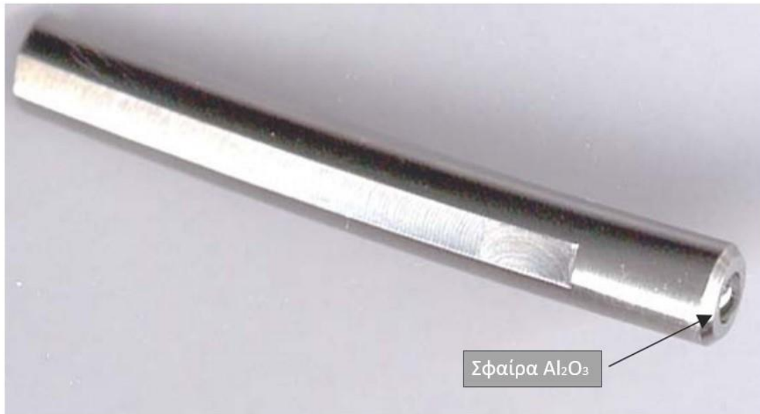
Εικόνα 5.9 Στυλίσκος τρίμετρου με σφαίρα αλουμίνας Al 2 O 3
