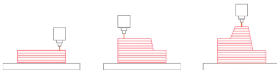
Εικόνα 2.1 Σχήμα της τεχνολογίας τρισδιάστατης εκτύπωσης υιοθετημένο από (Δημογιώργη, 2020)
