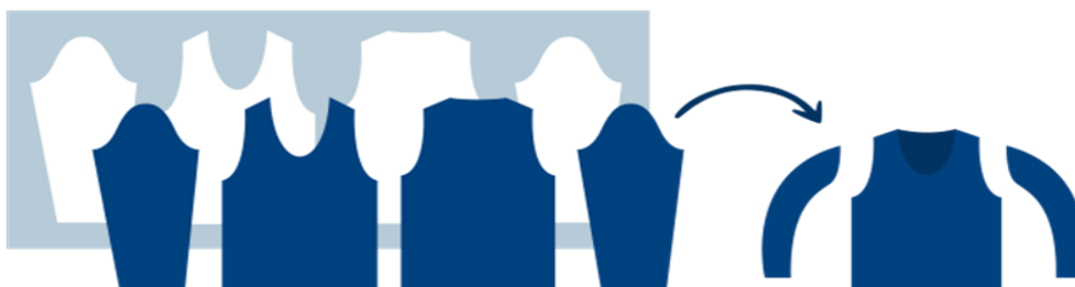
Εικόνα 10: Ανοιχτό γαλάζιο είναι η κοπή και ραφή. Το σκούρο μπλε είναι το Fully Fashion. Εκεί που δείχνει το βελάκι είναι το τελικό ρούχο που ενώνεται από τα δύο προηγούμενα (Πηγή: https://wholegarmentindia.com/about/ )
