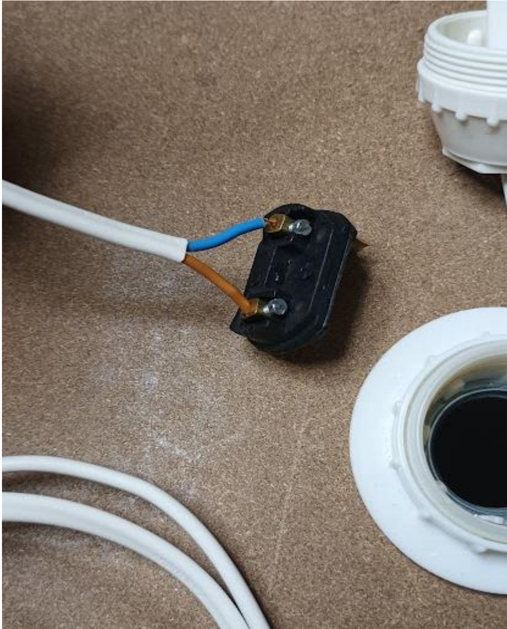
Εικόνα 20: Τοποθέτηση του ντουί και ένωση των καλωδίων τους φις στις επαφές του.
