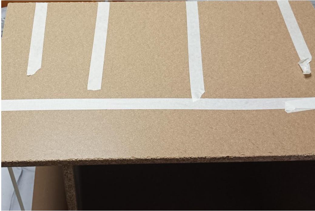
Εικόνα 12: Γυρίζουμε την κατασκευή από την άλλη πλευρά για την τοποθέτηση καρφιών.
