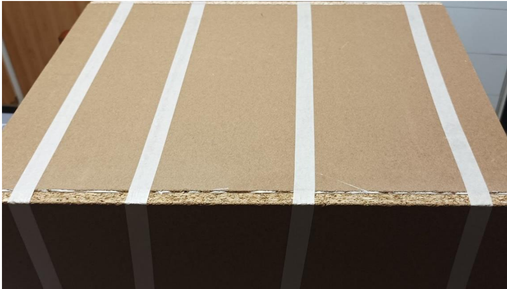
Εικόνα 11: Κάλυψη των σημείων επαφής με χαρτοταινία μέχρι να στεγνώσει η ξυλόκολλα.
