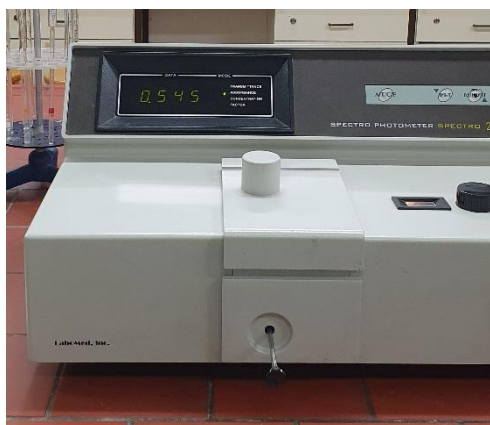
Σχήμα 26: Φασματοφωτόμετρο ορατού απλής δέσμης Spectro 23, Digital Spectrophotometer, Labomed, Inc., USA
