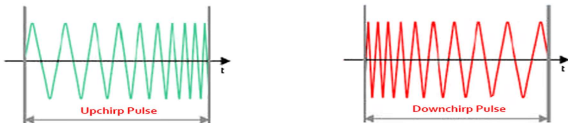
Σχήμα 1 Παλμός up-chirp (πράσινος) και down-chirp (κόκκινος)
