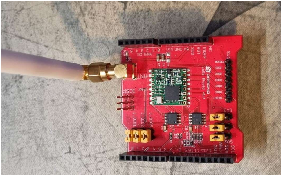
Εικόνα 7 Dragino LoRa Shield
