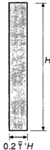
Σχήμα (3.17): Χαρακτηριστικό διάγραμμα του κατανεμημένου φορτίου αντιστήριξης σε κοκκώδες έδαφος χωρίς συνοχή (Twine and Roscoe 1999)
