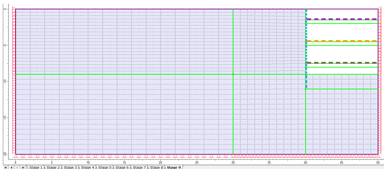
Σχήμα (5.8): Τελικό στάδιο εκσκαφής στο εδαφικό προσομοίωμα του προβλήματος.
