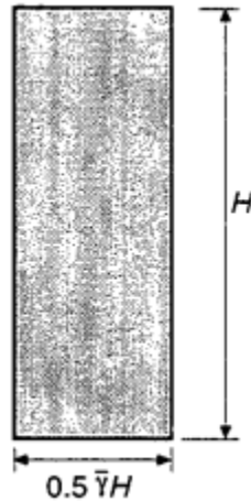
Σχήμα (3.20): Χαρακτηριστικό διάγραμμα του κατανεμημένου φορτίου αντιστήριξης σε έδαφος στιφρής αργίλου για άκαμπτο τοίχο. (Twine and Roscoe 1999)
