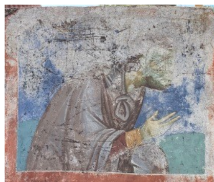
Εικόνα 4.19.(β.) Το ίδιο δοκίμιο μετά από 26 χρόνια από την κατασκευή του στο οποίο παρατηρούνται πληθώρα φθορών λόγω του ότι το συγκεκριμένο δοκίμιο είναι απευθείας εκτεθειμένο στις περιβαλλοντικές συνθήκες. Πηγή: Προσωπικό αρχείο.
