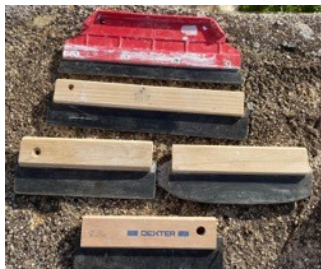
Εικόνα 4.4.(κ.) Τα εργαλεία λάστιχα που διαθέτουν ορθογώνιο ή καμπυλόγραμμο σχήμα και φέρουν μια ξύλινη ή πλαστική λαβή με τα οποία επιμελούνται τα περιθώρια του στρώματος κονιάματος. Πηγή: Προσωπικό αρχείο.
