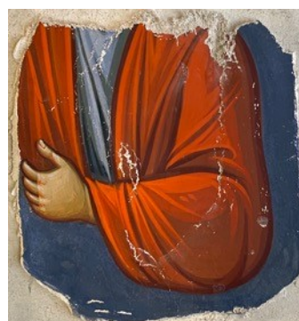
Εικόνα 4.11.(β.) Δοκίμιο με προσθήκη ζωικού λίπους και άμυλο στο κονίαμα και ως συνδετικό για τα χρώματα έχει χρησιμοποιηθεί το ζωικό λίπος. Πηγή: Προσωπικό αρχείο.
