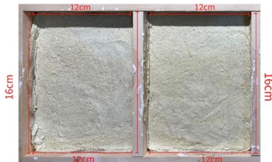
Εικόνα 5.(ε.) Τα δύο δοκίμια που κατασκευάζονται έχουν διαστάσεις το καθένα 16cm x 12cm. Πηγή: Προσωπικό αρχείο.
