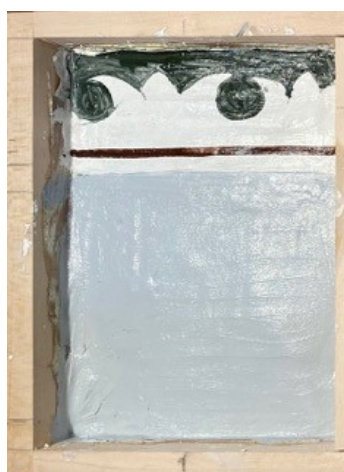
Εικόνα 5.(η.) «Στιλβωμένο» το φόντο στο δοκίμιο με συνδετικό υλικό για τις χρωστικές μόνο το ασβεστόνερο. Πηγή: Προσωπικό αρχείο.
