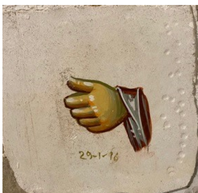
Εικόνα 4.11.(α.) Δοκίμιο με ζάχαρη στην σύστασή του κονιάματος. Πηγή: Προσωπικό αρχείο.
