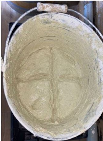
Εικόνα 5.(α.) Το κονίαμα που αποτελεί το υπόστρωμα των δοκιμίων αποτελείται από παλιωμένο ασβέστη + άμμο ποταμίσια 3:1 και βρασμένο άχυρο, λινάρι και το νερό με την κυτταρίνη που έβρασε το άχυρο. Πηγή: Προσωπικό αρχείο.
