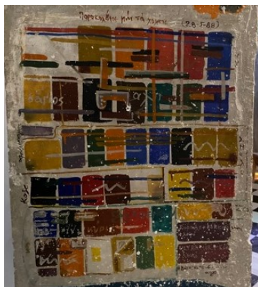
Εικόνα 4.12.(α.) Τεστ για να ανιχνευθούν ποια χρώματα αντιδρούν ή όχι με τον ασβέστη – ασβεστοκονίαμα. Πηγή: Προσωπικό αρχείο.
