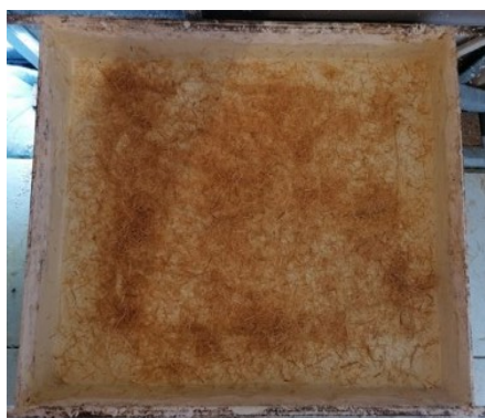
Εικόνα 4.2.(κγ.) Το λινάρι έχει απλωθεί ομοιόμορφα σε όλη την έκταση του κονιάματος. Πηγή: Προσωπικό αρχείο.
