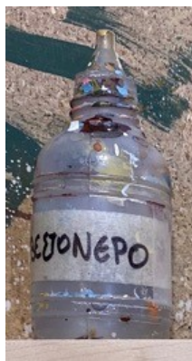
Εικόνα 5.(ιε.) Ανόργανο συνδετικό υλικό για τις χρωστικές ασβεστόνερο 1:10 (1 μέρος ασβέστης και 10 μέρη νερό). Πηγή: Προσωπικό αρχείο.
