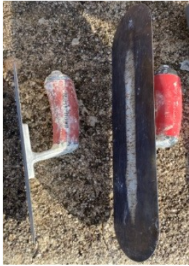
Εικόνα 4.4.(ιθ.) Επίπεδη σπάτουλα σε μικρό και μεγάλο μέγεθος που διαθέτει ένα οβάλ σχήμα το μεταλλικό στέλεχος της και έχει μια ειδική χειρολαβή. Με το εργαλείο αυτό ισιώνεται και δίνεται το τελικό φινίρισμα στο κάθε στρώμα κονιάματος. Πηγή: Προσωπικό αρχείο.
