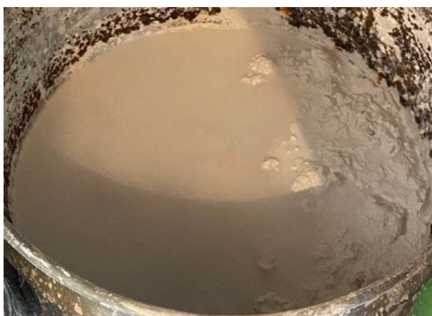
Εικόνα 4.1.1(α.) Ο σβησμένος και παλαιωμένος ασβέστης που χρησιμοποιεί ο κ. Σέργιος Σεργιάδης για την παρασκευή των διαδοχικών στρωμάτων κονιάματος που προορίζονται ως υπόστρωμα για τα έργα νωπογραφίας του. Πηγή: Προσωπικό αρχείο.
