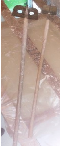
Εικόνα 4.4.(η.) Δύο τσάπες που χρησιμοποιούνται στην ανάδευση των διάφορων ασβεστοκονιαμάτων που προορίζονται ως υπόστρωμα μιας νωπογραφίας. Πηγή: Προσωπικό αρχείο.
