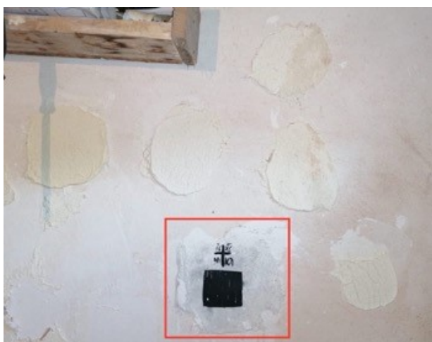
Εικόνα 4.11.(ε.) Δείγματα κονιαμάτων τοποθετώντας στην δομή διαφορετικές ποσότητες αδρανών υλικών, στο κόκκινο πλαίσιο επισημαίνεται το τελικό δείγμα κονιάματος όπου μετά την σωστή αναλογία φυτικών αδρανών υλικών άχυρου και λιναριού δεν δημιουργούνται ρωγματώσεις στην επιφάνεια του κονιάματος και φέρει μια ενιαία και ομοιόμορφη συνοχή. Πηγή: Προσωπικό αρχείο.
