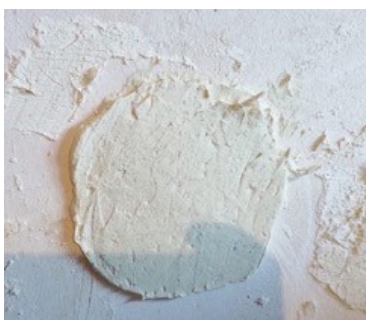
Εικόνα 4.11.(γ.) Δείγμα κονιάματος που διαθέτει ασβέστη + άμμο 3:1 και βρασμένο άχυρο. Πηγή: Προσωπικό αρχείο.
