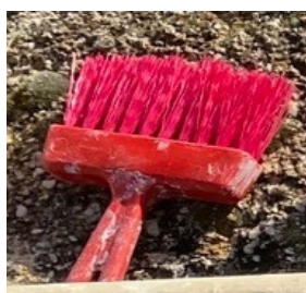
Εικόνα 4.4. (ια.) Πλαστικό σκουπάκι με το οποίο πραγματοποιείται το γάνωμα – αστάρωμα. Πηγή: Προσωπικό αρχείο.
