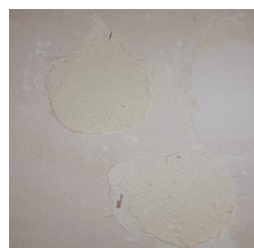
Εικόνα 4.11.(δ.) Δοκίμια κονιαμάτων κατά την τοποθέτηση μέσα στην σύσταση του κονιάματος διάφορων ποσοτήτων φυτικών ινωδών αδρανών υλικών άχυρου και λιναριού. Πηγή: Προσωπικό αρχείο.
