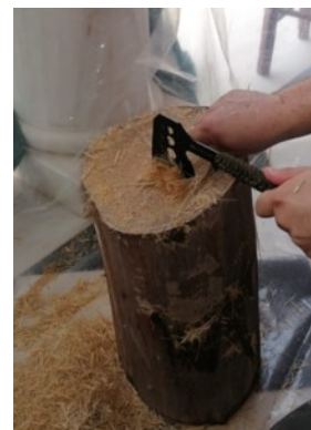
Εικόνα 4.2.(ιη.) Τεμαχισμός με τσεκούρι ανά 3cm σε μήκος, κάθε ποσότητας λιναριού. Πηγή: Προσωπικό αρχείο
