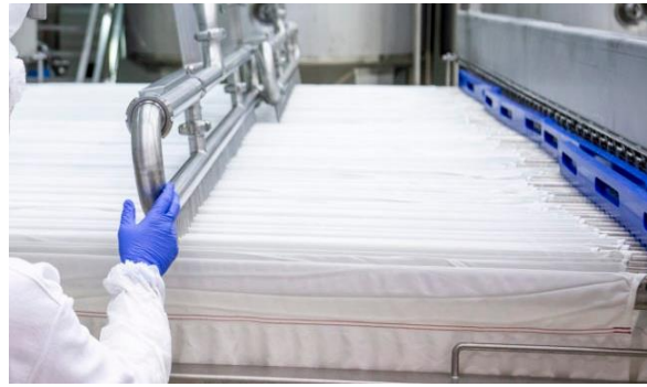
Εικόνα 5.14. Αριστερά: Κατίκι Δομικού. Δεξιά: Στο σύγχρονο εργοστάσιο της εταιρείας Δομοκός Α.Ε. ακολουθείται η παραδοσιακή μέθοδος διαχωρισμού του ορού με ‘τσαντίλα’ χρησιμοποιώντας όμως αυτοματοποιημένο σύστημα στραγγίσματος.
