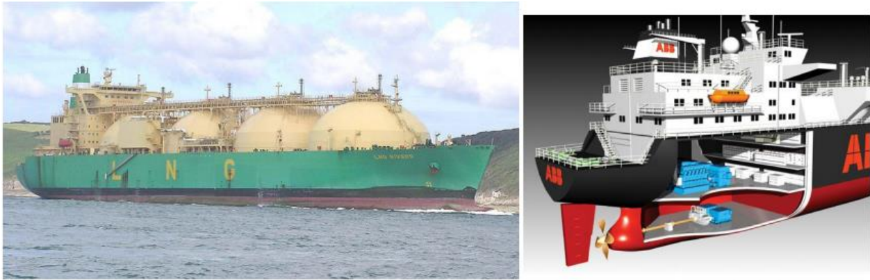
Εικόνα 2.3 α) Μηχανοκίνητο LNG από ατμοστρόβιλους των 32 MW β) Σχηματικό ενός LNG των 40 MW με ηλεκτρικό σύστημα πρόωσης διπλού καυσίμου (ABB). [15]
