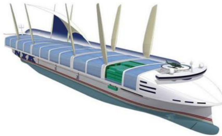
Εικόνα 5.5 Πλοίο με σύστημα ηλιακής πρόωσης [26]
