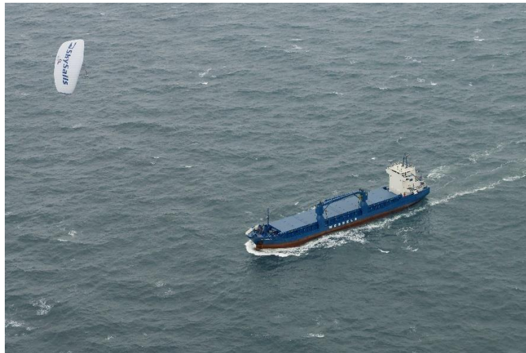
Εικόνα 5.3 Πλοίο με χρήση του συστήματος πρόωσης Skysails. [47]
