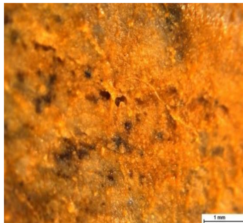
Εικόνα 5.25.: Δείγμα Στρώματος 2 μετά τον χημικό καθαρισμό 10% επίθεμα.
