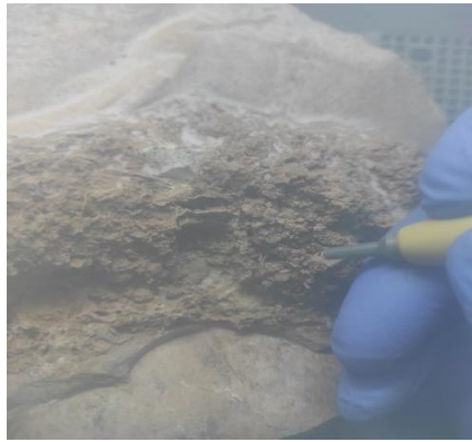
Εικόνα 5.43.: Φωτογραφική απεικόνιση δείγματος του Στρώματος 1 κατά την δοκιμή καθαρισμού του με Ψηγματοβολή
