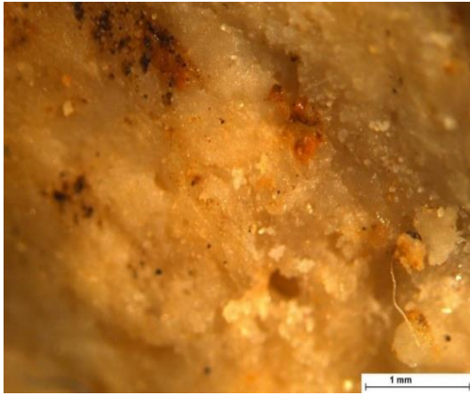
Εικόνα 5.32.: Δείγμα Στρόματος 2 μετά τον χημικό καθαρισμό 40% με επίθεμα.
