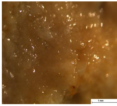
Εικόνα 5.29.: Δείγμα Στρώματος 2 μετά τον χημικό καθαρισμό 20% με επίθεμα.
