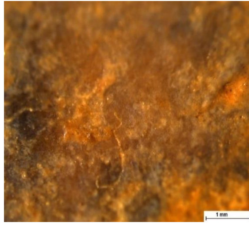
Εικόνα 5.27.: Δείγμα Στρώματος 3 μετά τον χημικό καθαρισμό 10% με επίθεμα.
