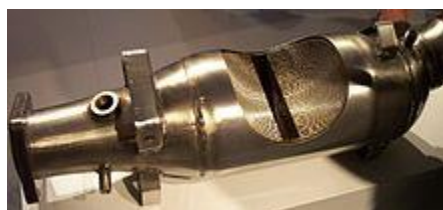
Εικόνα 2: Εσωτερικό τμήμα μετατροπέα μεταλλικού πυρήνα
