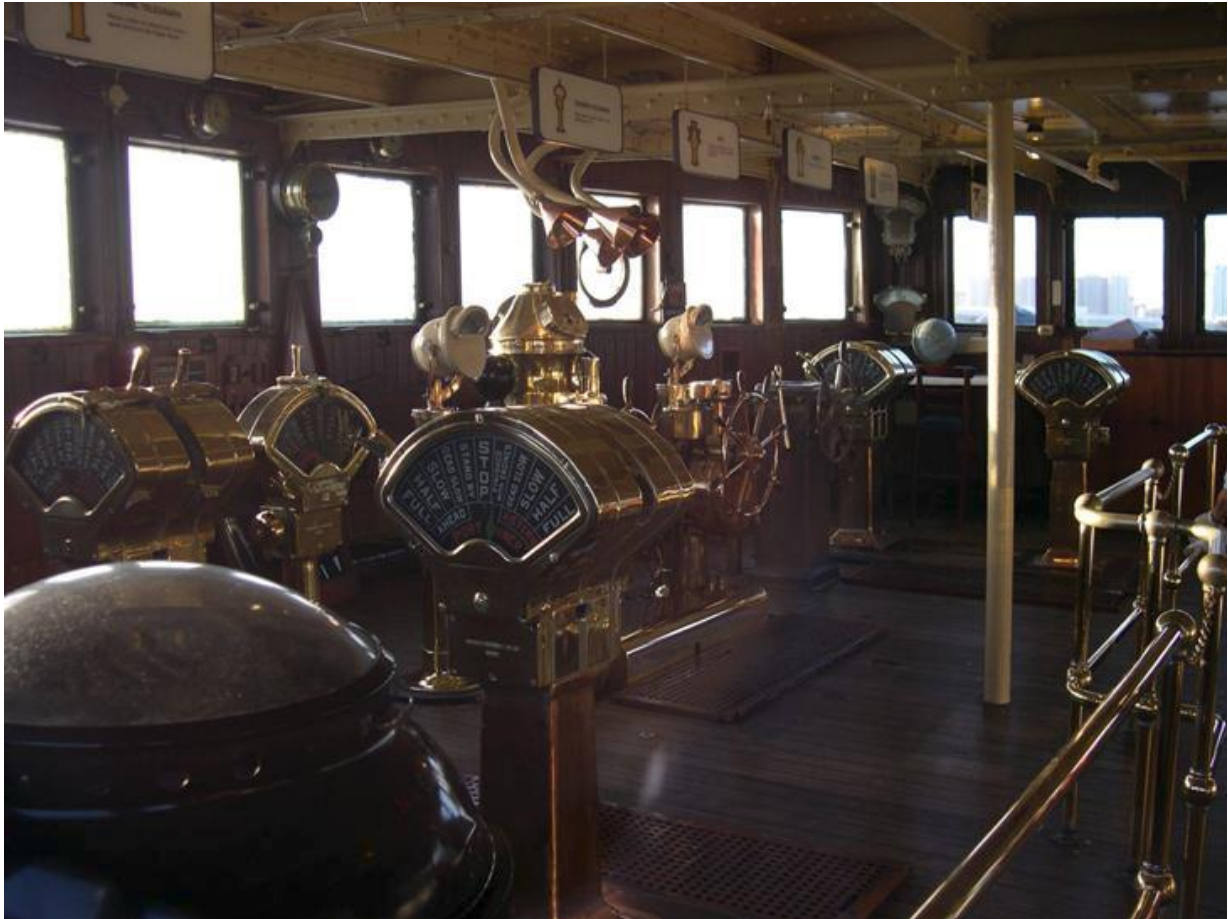
Εικόνα 2. Εξοπλισμός γέφυρας στο παρελθόν (QUEEN MARY 1934). Διακρίνονται οι Engine telegraph, steering telegraph, η μαγνητική πυξίδα, το πηδάλιο, το κλινόμετρο και οι σωλήνες επικοινωνίας.
