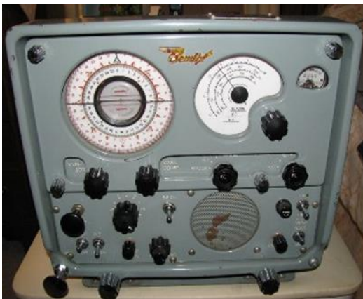
Εικόνα 107. Ραδιογωνιόμετρα περιστρεφόμενης κεραίας και ψηφιακό
