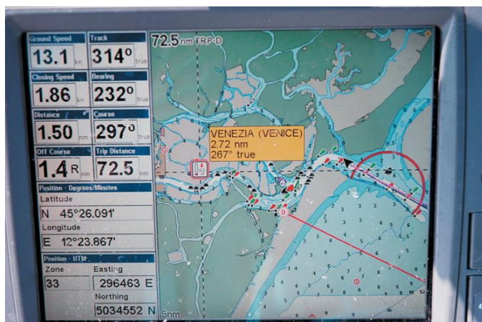
Εικόνα 101. Δέκτης GPS σε πλοίο με οθόνη απεικονίσεως στοιχείων ηλεκτρονικού χάρτη.
