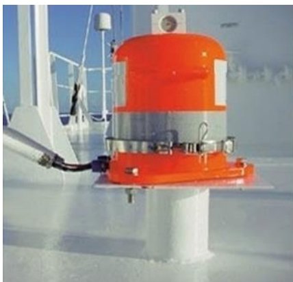
Εικόνα 106. Κάψουλα καταγραφής και προστασίας δεδομένων
