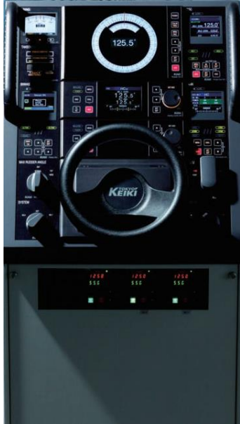
Εικόνα 88. Το control πηδαλιουχίας. Το κουτί κάτω από το τιμόνι περιέχει την γυροπυξίδα
