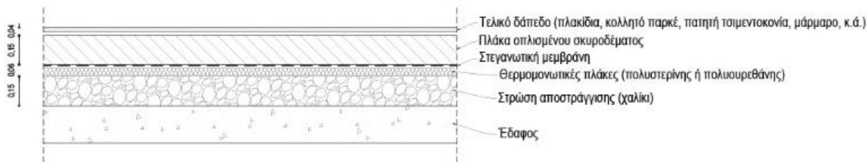
Εικόνα 173 Σκίτσο κατασκευής δαπέδου σε επαφή με το έδαφος
