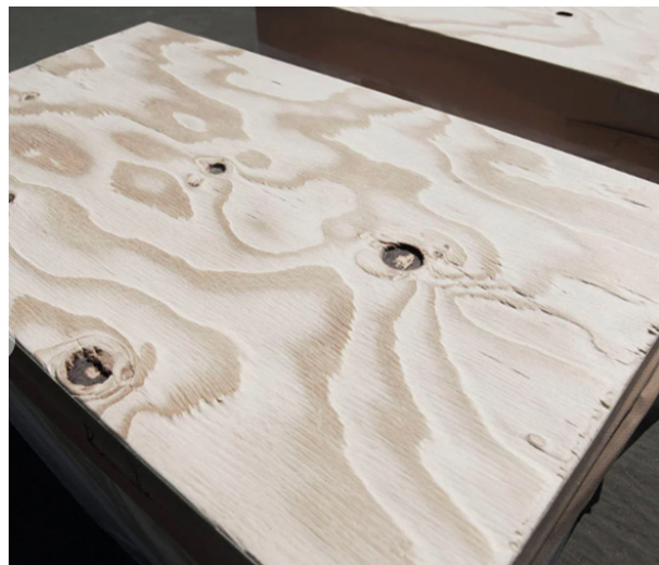
Εικόνα 71: Σκίτσο διαδικασίας Uduki Εικόνα 72: Ξύλο υπό την επεξεργασία Uduki
