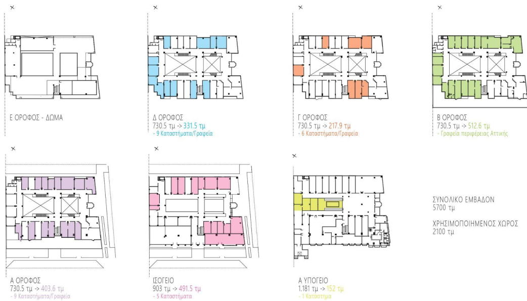
Εικόνα 15: Σχεδιάγραμμα αποτύπωσης εκμεταλλευόμενων χώρων κτιρίου.
